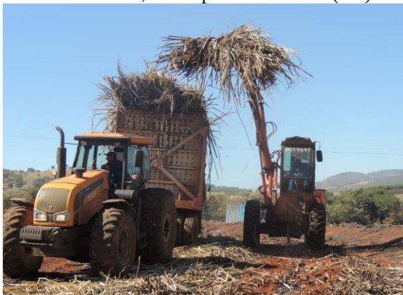
Foto 05 – Carregamento de cana após corte manual utilizando trator com guindaste e transporte com reboque de trator em área dobrada, município de Rubiataba (GO).
