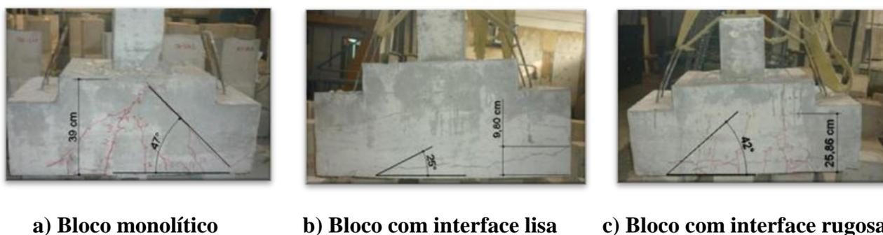
Figura 66 – Blocos ensaiados experimentalmente – identificação do ângulo de inclinação das bielas
