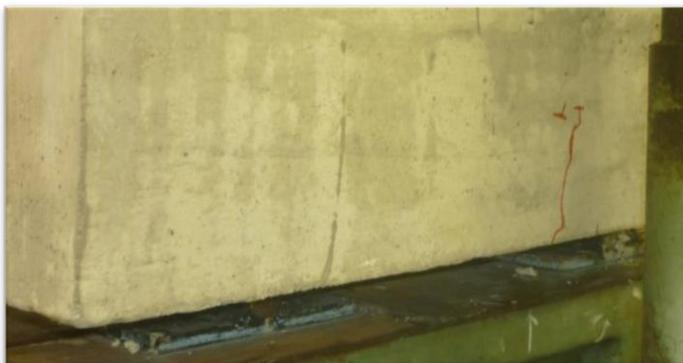
Figura 44 – Chapas metálicas sobre roletes em substituição das estacas
