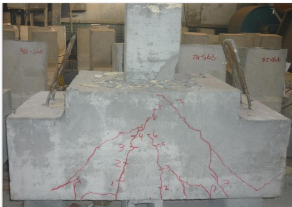
Figura 67 – Bloco monolítico após a ruptura: formação das bielas de compressão identificadas pelo mapa de fissuração
