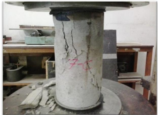
**b) Ensaio a compressão do concreto**
