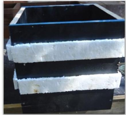
Figura 35 – Chapas de isopor para criação de parede rugosa do cálice
