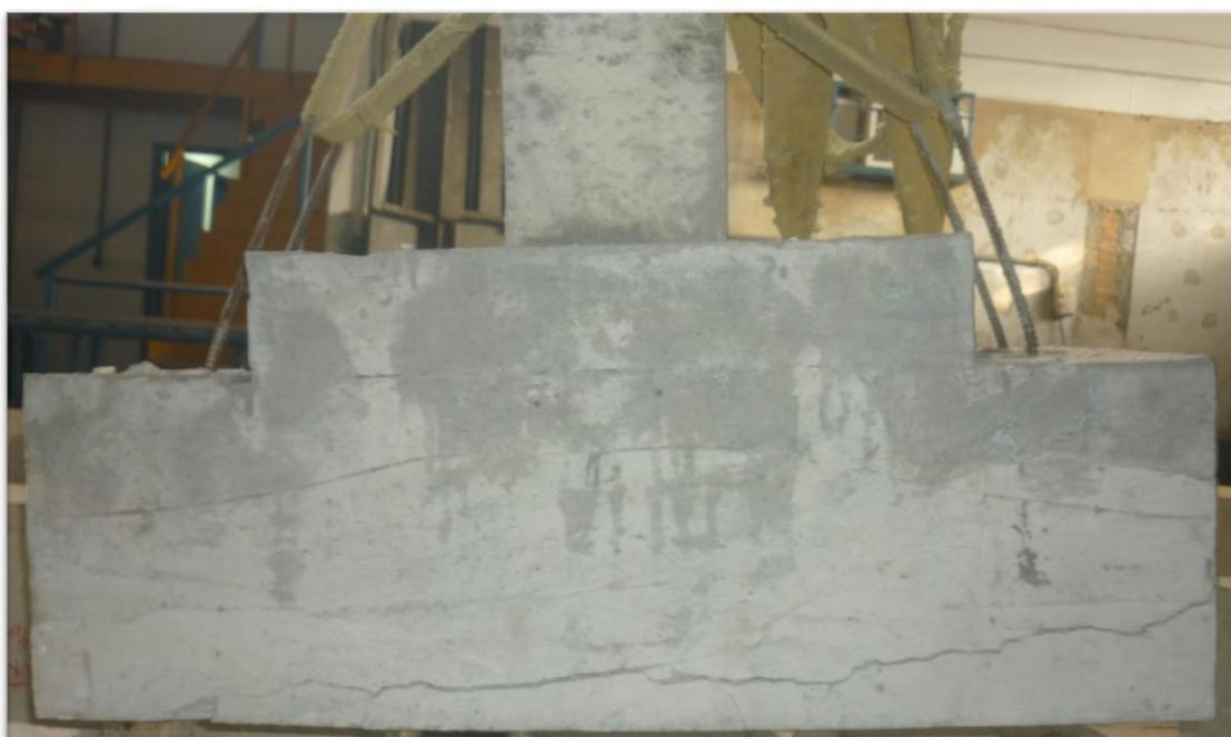
Figura 68 – Bloco com conformedo lisa do pilar e do cálice após a ruptura: não foi observada a formação de bielas de compressão
