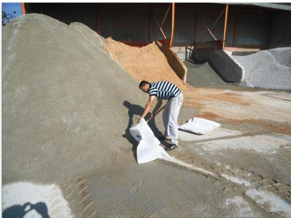
Figura 45 – Coleta de materiais no estoque da concreteira
