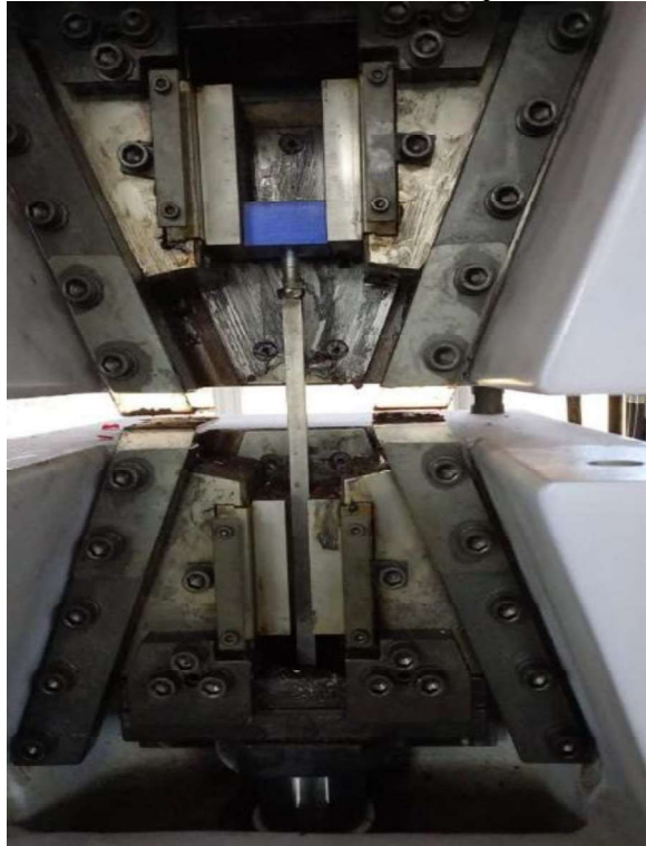
Figura 27: Parafuso soldado ao extensor para teste de tração.
