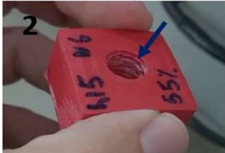
Figura 36: Peça 2 de ABS após o pré-teste, onde a seta azul aponta para local de rompimento dos filetes de roscas.
