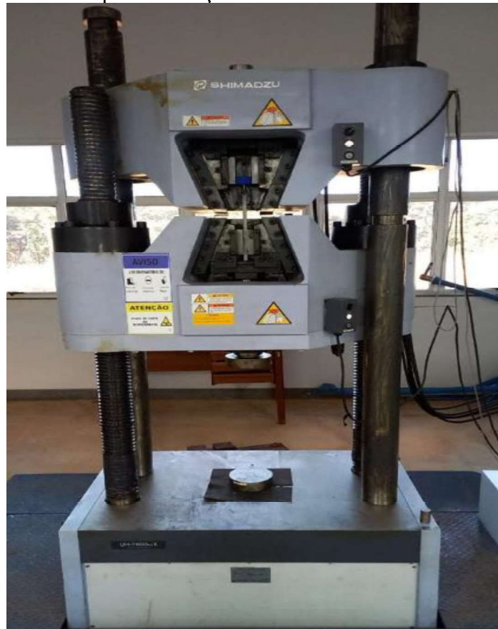
Figura 24: Máquina de tração modelo UHF 600kNX Shimadzu.
