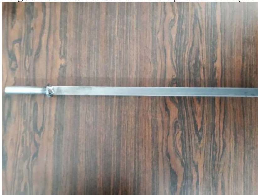
Figura 26: Parafuso soldado ao extensor para teste de tração.
