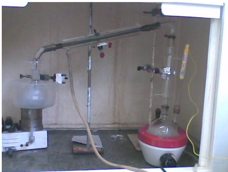
Figura 40. Foto da formação dos produtos durante a reação de craqueamento termo-catalítico utilizando bauxita “ in natura ”.
