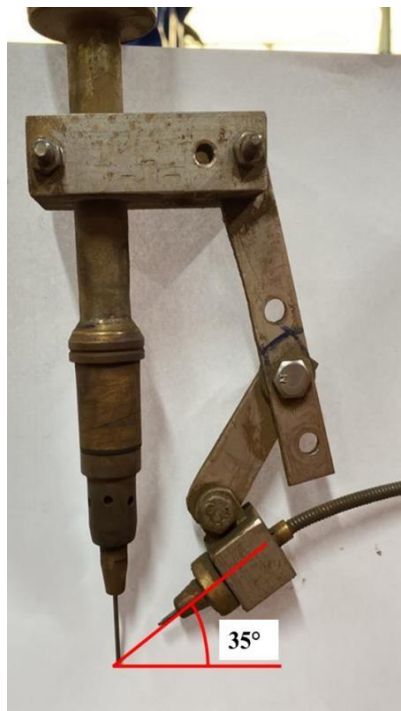
Figura 3. 3: Suporte com alimentador de arame não-energizado acoplado a tocha.
