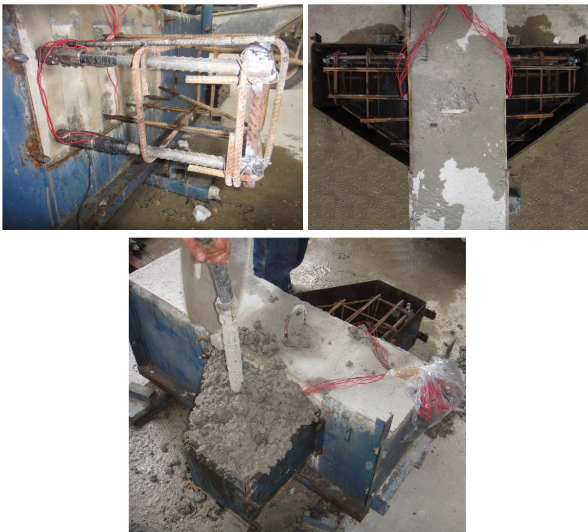
Figura 3.21 – Preparo e moldagem dos consolos do modelo M4, com chave de cisalhamento.
