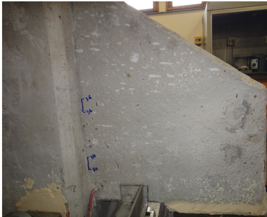
(a) Início da fissuração do modelo M8A no contorno das chaves de cisalhamento.
