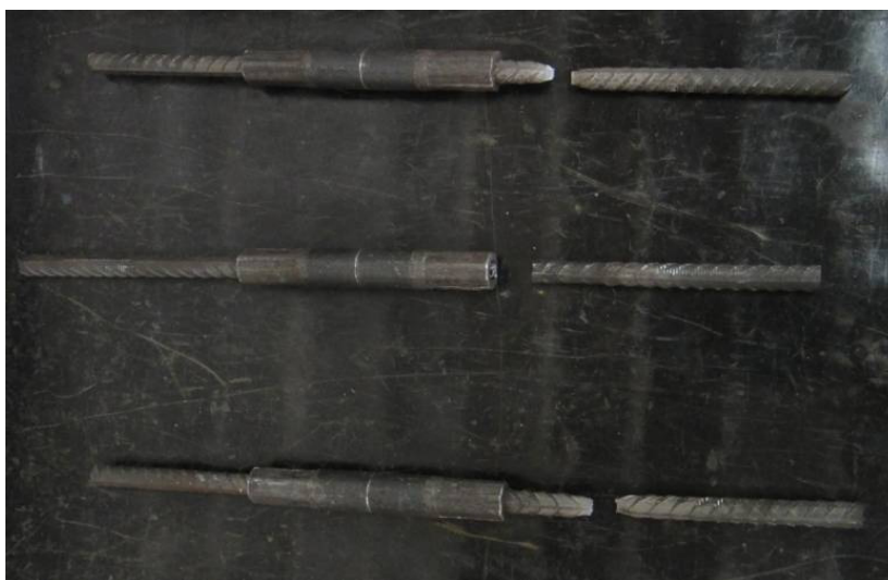
Figura 3.3 - Amostras de barras emendadas com luva após o ensaio de tração.
