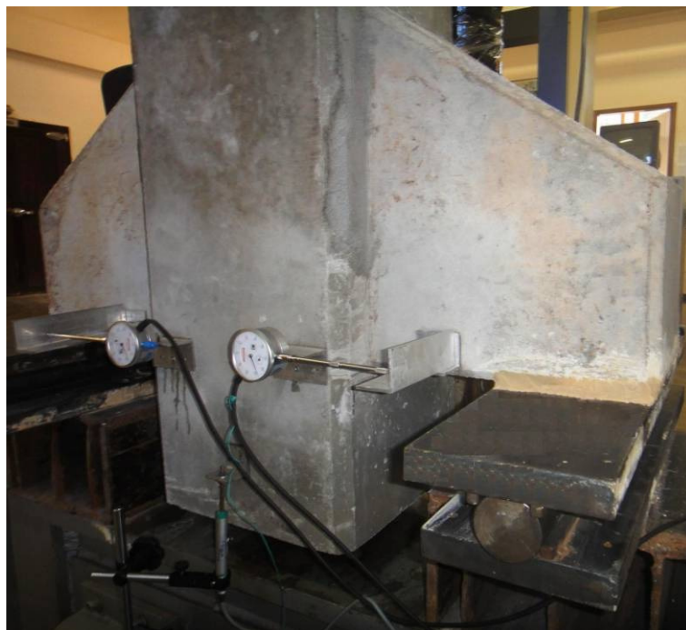
Figura 3.30 - Transdutores de deslocamentos fixados para o ensaio.
