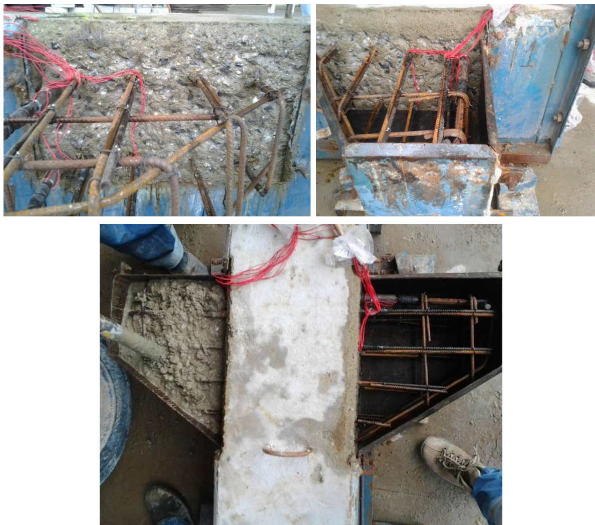
Figura 3.24 - Preparo e moldagem dos consolos do modelo M7, com superfície intencionalmente rugosa.
