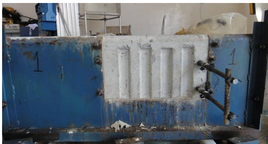
Figura 3.8 - Interface pilar-consolo com as chaves de cisalhamento no modelo M6, antes da aplicação do epóxi para concretagem do consolo.
