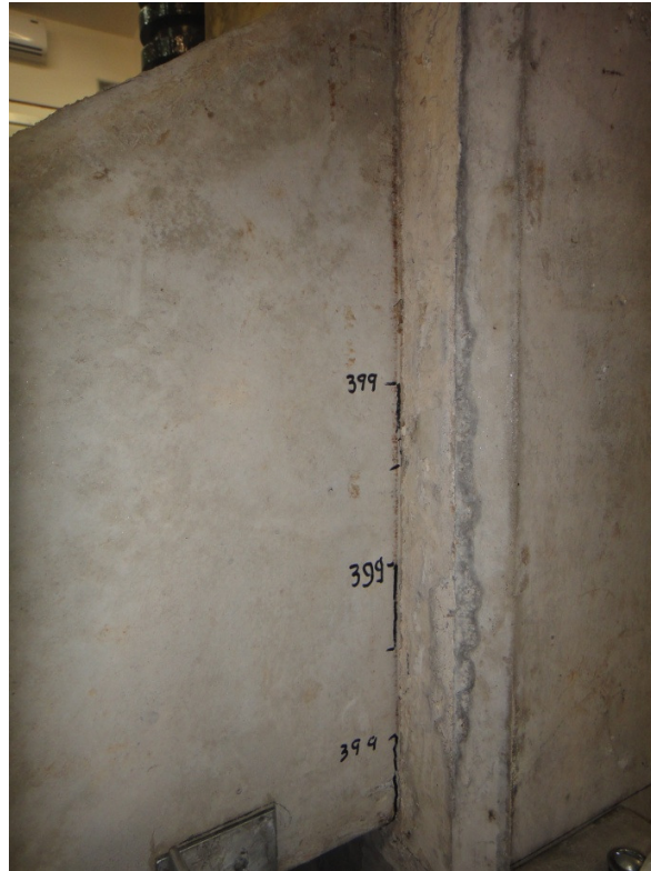
(a) Início da fissuração do modelo M4A no contorno das chaves de cisalhamento.
