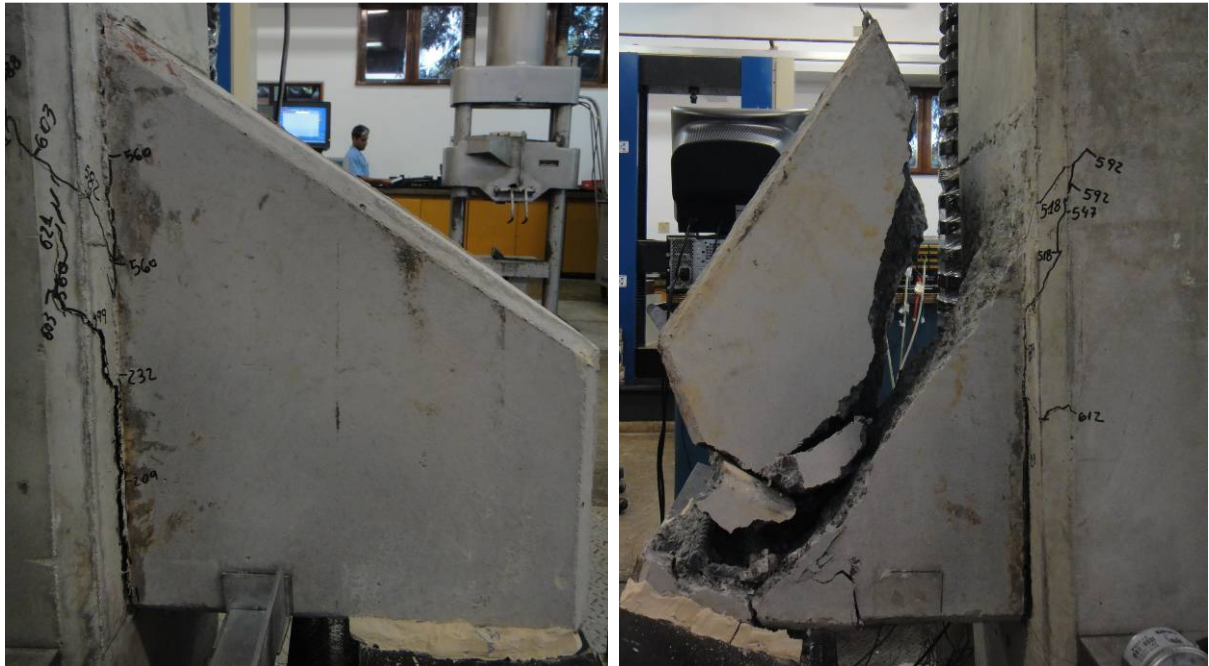
(c) Fissuração do consolo 1 ao final do ensaio
