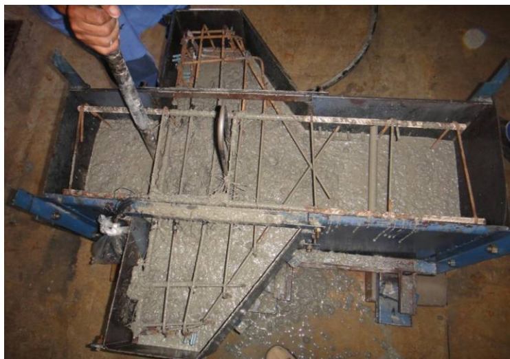
Figura 3.17 - Concretagem e adensamento do modelo monolítico M2.
