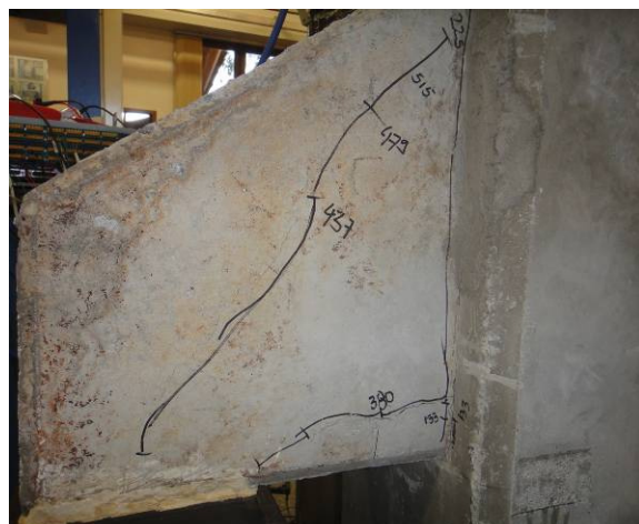
(d) Fissuração no consolo 2 ao final do ensaio
