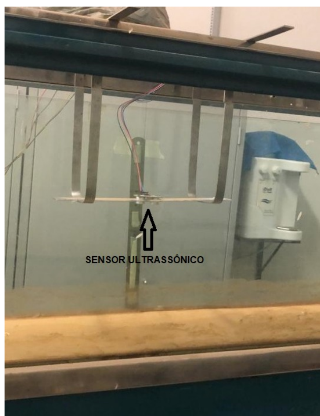
Figura 3.13 – Instalação do sensor com suporte para medição do escoamento supercrítico.
