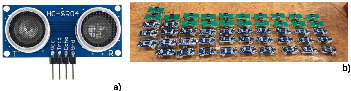
Figura 3.11 - Sensor ultrassônico para Arduino utilizado no monitoramento das cotas no canal artificial a) esquema físico, modelo HC-SR04; b) amostragem dos sensores para testes de precisão.
