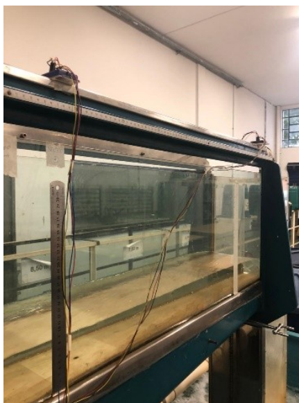
Figura 3.15 - Detalhe de posição do sensor ultrassônico e da régua milimetrada graduada instaladas no canal artificial.
