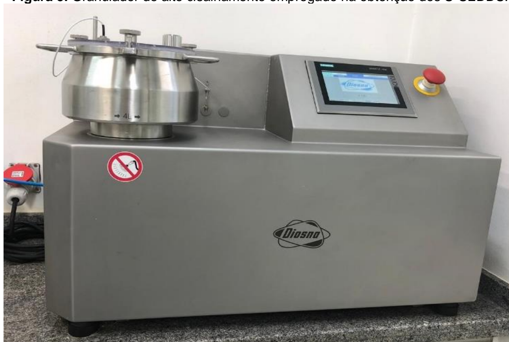
Figura 5. Granulador de alto cisalhamento empregado na obtenção dos S-SEDDS.
