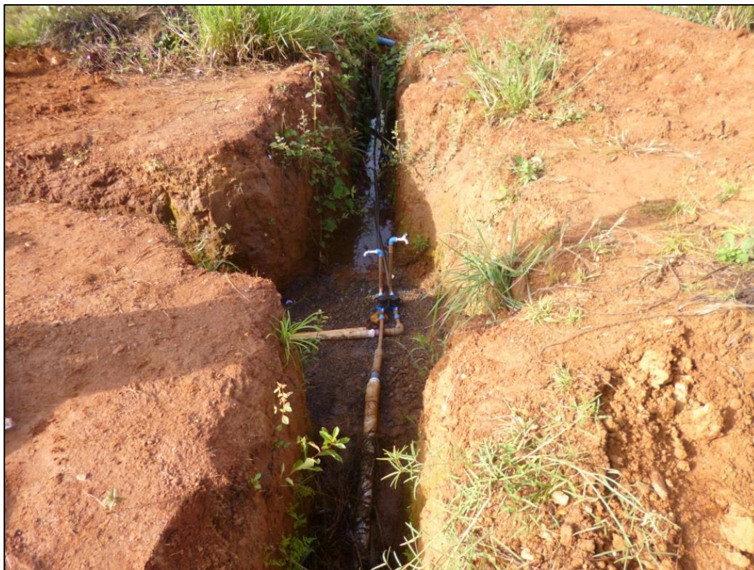
Figura 29: Torneiras para realização da amostragem do Resíduo de Fossa e Tanque Séptico tratado.
