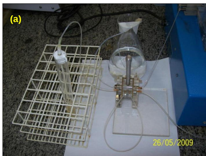
Figura 18- Foto do Injetor/comutador manual e da alça de amostragem (a) , tubos usados nos testes (b) .
