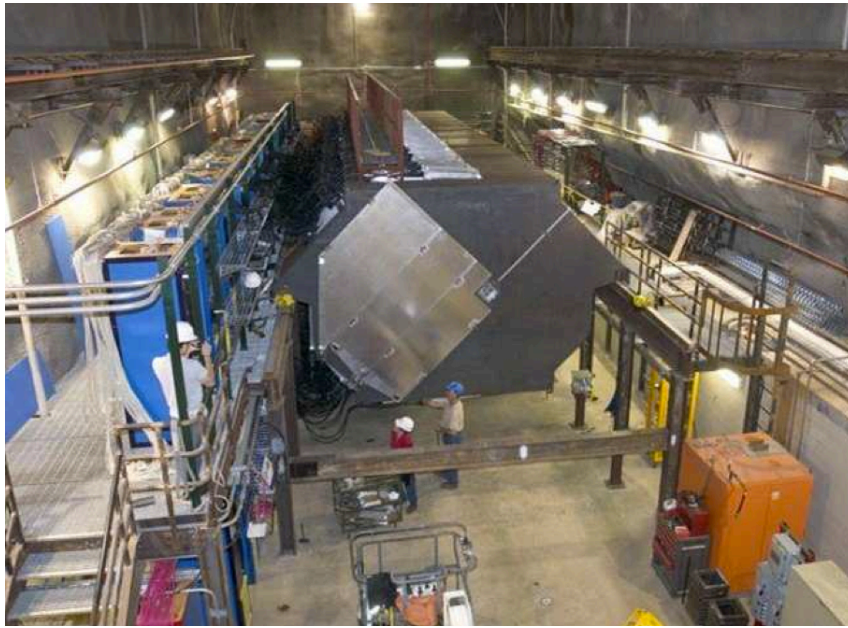
Figura 4.4: Foto tirada durante a construção do Near Detector, onde é possível ver a região instrumentada do detector.
