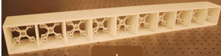
Figura 1.7-Metamaterial com ressonadores internos.
