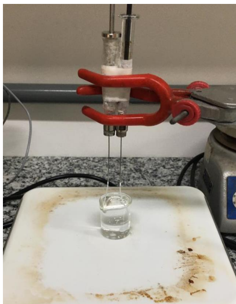
Figura 37. Sistema de extração bifásico.
