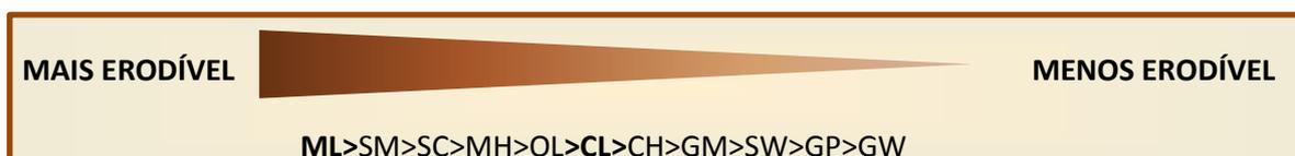
**Figura 16 – Escala para a medida de erodibilidade, estabelecida por meio da análise granulométrica e das medidas de plasticidade em amostras deformadas.**
