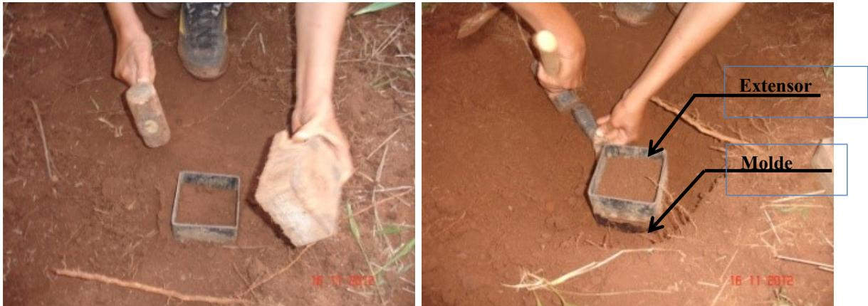
**Figura 8 - Retiradas de amostras indeformadas para ensaio de Inderbitzen.**
