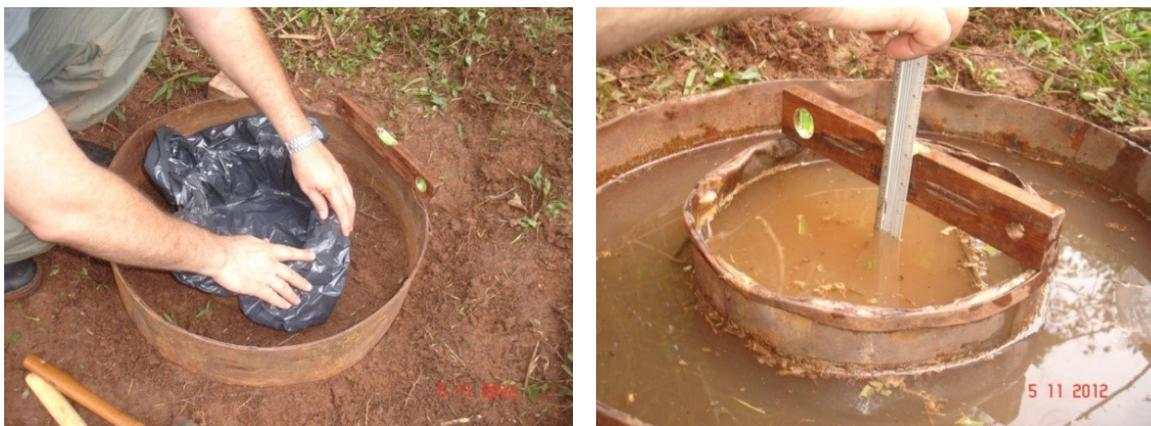
Figura 7 – Ensaio com infiltrômetro metálico de anéis concêntricos.
