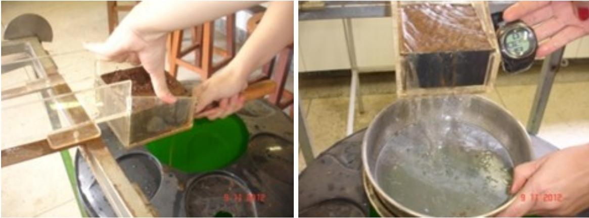
**Figura 11 - Realização do ensaio no aparelho de Inderbitzen**
