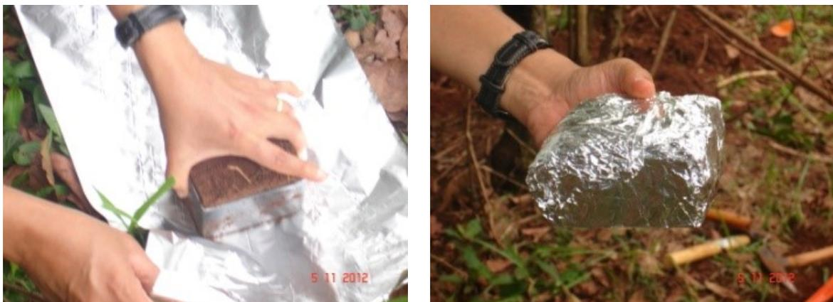
**Figura 9 - Acondicionamento das amostras indeformadas.**
