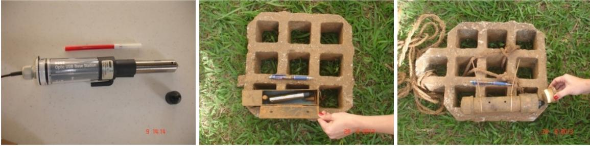
**Figura 4 – Vista do equipamento *HOBOTest U20 001-01-TI Water Level* e das bases de concreto com estrutura metálica e em PVC para o acondicionamento e proteção do equipamento.**
