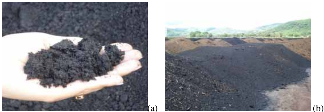
Figura 2.3 – (a) Cinza do bagaço de cana-de-açúcar; (b) Preparo da cinza para compostagem. Foto: Janaina Silva
