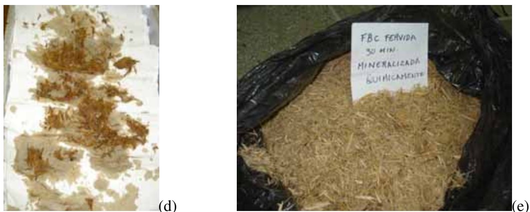
Figuras 4.2 – Sequência do processo de mineralização com produtos químicos; (a) Pesagem dos componentes químicos; (b) Solubilização; (c) Impregnação das fibras pela solução química; (d) Secagem das fibras ao ar livre; (e) Aparência após mineralização efetuada.
