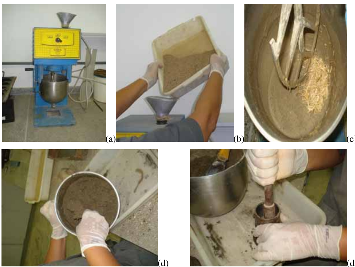
Figura 4.3 – Sequência do processo de moldagem dos corpos-de-prova; (a) Argamassadeira; (b) Mistura dos componentes sólidos; (c) Mistura da FBC; (d) Consistência final da argamassa; (e) Moldagem e compactação manual dos corpos-de-prova. Fotos: Janaina F. Silva
