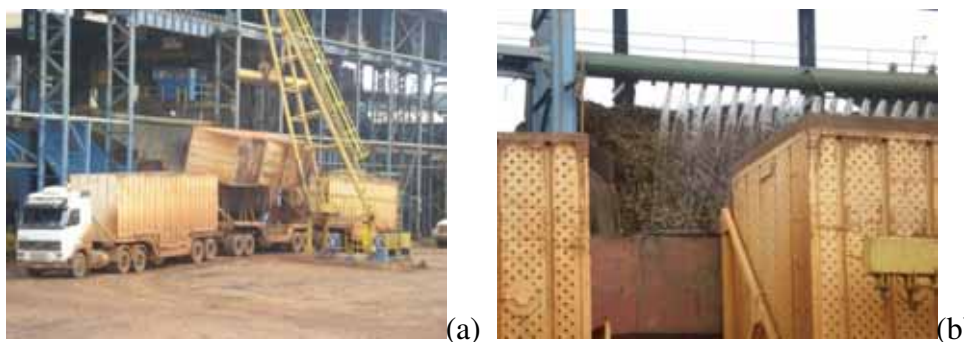
Figuras 5.1 – (a) Descarregamento da cana-de-açúcar; (b) Lavagem para remoção das impurezas. Fotos: Janaina F. Silva
