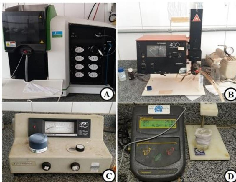
**Figura 57.** Instrumentos utilizados para realizar as análises da fertilidade dos solos. *Perkin Elmer Atomic Absorption Spectrometer* (A); *Espectrofotômetro Corning 400 Flame Photometer* (B); *Espectrofotômetro UV/VIS* com comprimento de onda de 660 nanômetros, *Electronic 20* (C); *Phmetro Digimed DM20-digigran* (D).
