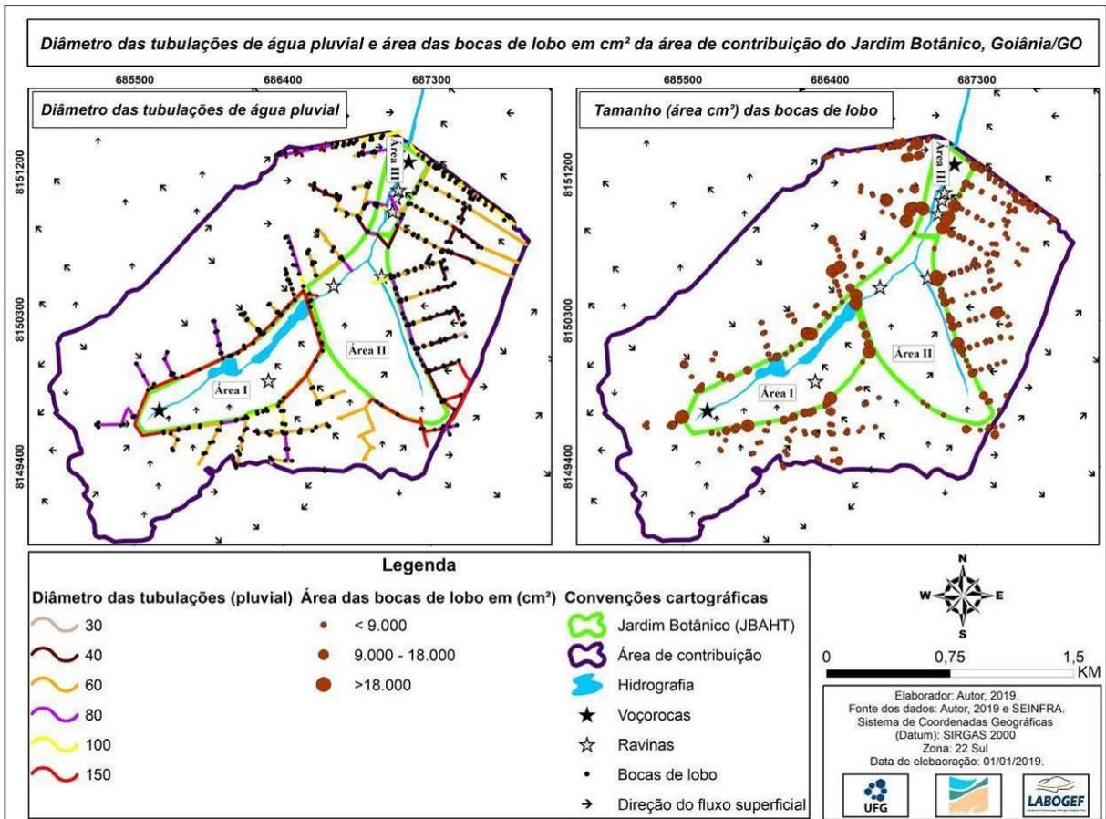
**Figura 20.** Diâmetro das tubulações de água pluvial e área da entrada de água nas bocas de lobo em cm<sup>2</sup> da área de contribuição do parque Jardim Botânico de Goiânia/GO.
