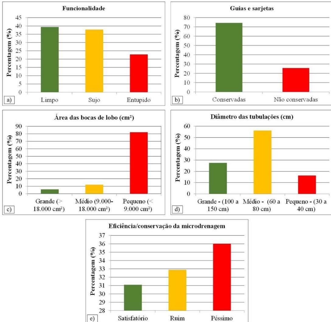
**Figura 22.** Percentagem dos elementos e da eficiência e condição da microdrenagem. Percentagem da funcionalidade das bocas de lobo (Limpa, suja e entupida) (a); Percentagem das guias e sarjetas (conservada e não conservada) (b); Percentagem da área das bocas de lobo (cm<sup>2</sup>) (c); Percentagem do diâmetro das tubulações (cm) (d); Percentagem da eficiência/conservação da microdrenagem (e).
