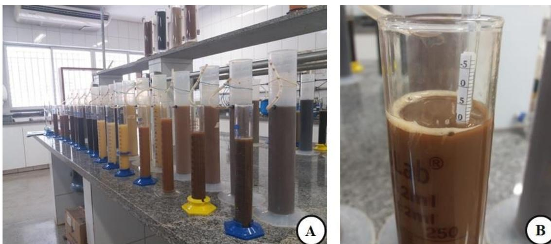
**Figura 56.** Amostras de solo dentro das provetas de 500 ml para realizar as leituras (A). Leitura com Densímetro de Bouyoucos dentro de uma das provetas de 500 ml (B).
