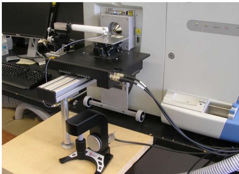
Figura 24. Espectrômetro de massas Thermo Fisher Scientific LTQ XL íon trap linear equipado com uma fonte de ionização DESI utilizado nos experimentos de imagem.
