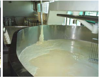
Enchimento do tanque de fabricação de queijo
