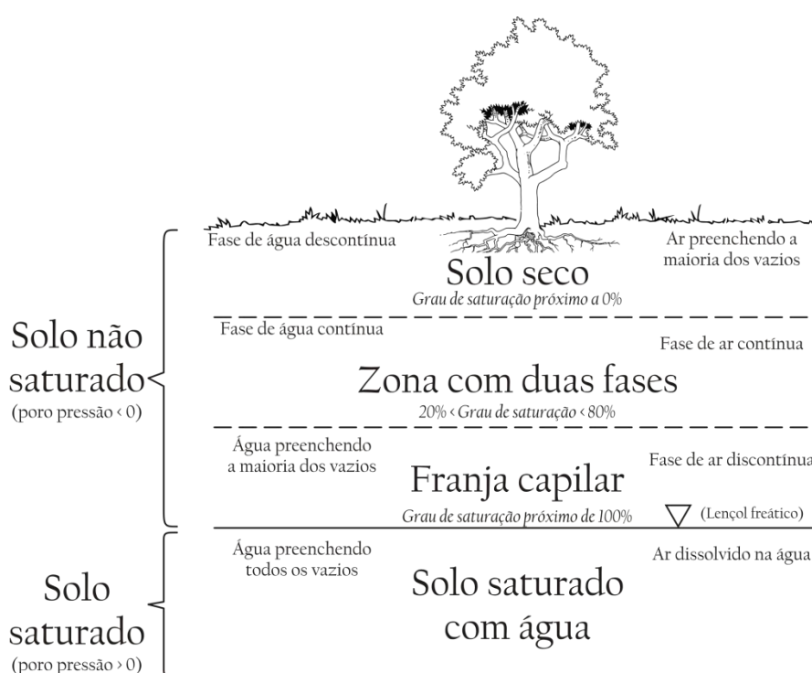
Figura 1.2: Solo saturado e solo não saturado
