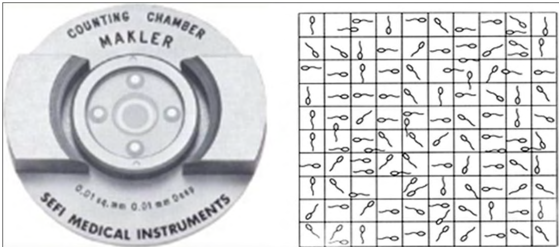
Figura 4. Câmara de Makler e sua representação gráfica à direita. O número de espermatozoides contados em qualquer faixa de dez quadrados indica a concentração em milhões por mL. Fonte: http://www.crh.com.br/crh.asp?pasta=33&livro=1&txt=3
