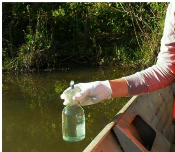
**Figura 5.2.** Frasco Winkler utilizado nas coletas de amostras para análises de OD e DBO. Além de outros fatores, esses não permitem trocas gasosas entre as amostras e o meio externo. Fonte: Autora (2014).
