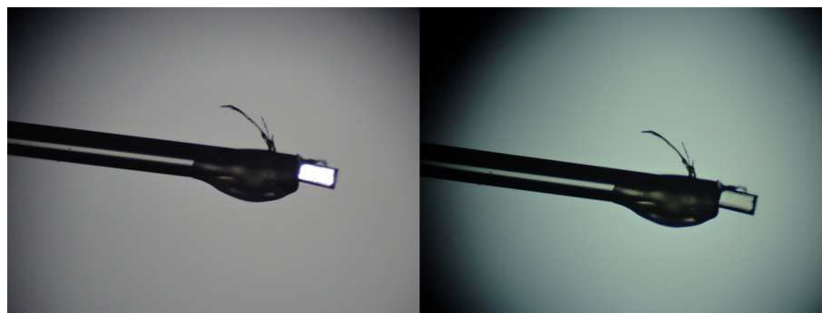
Figura 4.7: Cristal visto em um microscópio com luz polarizada.
