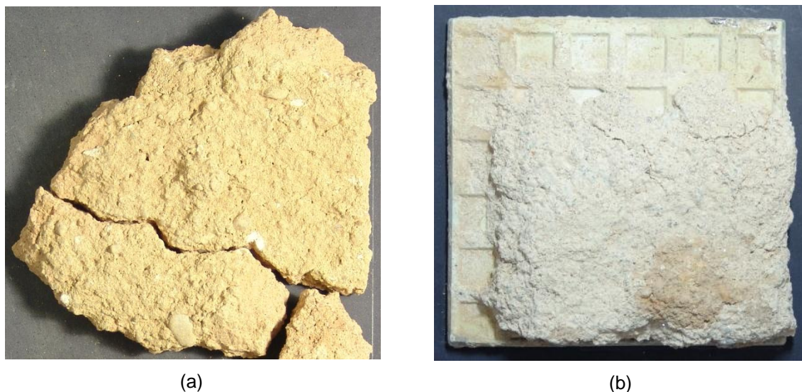
Figura 3. 18 – (a) Torrões esbranquiçados, provavelmente de cal nas argamassas, na amostra PT-VO-A6 do Caso 1 e (b) diferenças de colorações da argamassa na própria amostra PT-AS-SI3 do Caso 2.
