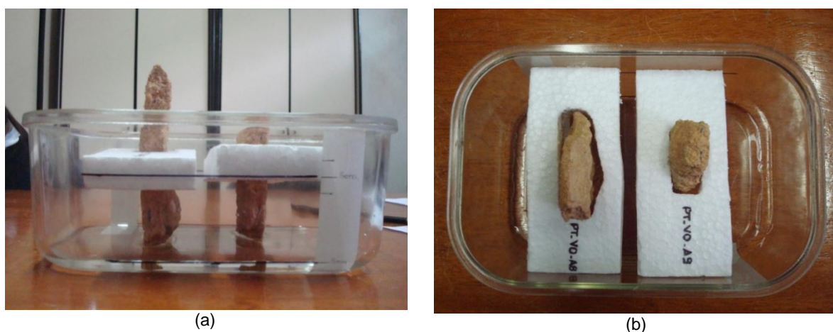
Figura 3. 8 – Adequação do anteparo de isopor para execução do ensaio de absorção de água por capilaridade: (a) vista lateral e (b) vista superior do recipiente.
