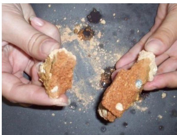
Figura 3. 27 – Argamassa histórica do Caso 1 após fratura e a aspersão de fenolftaleína.
