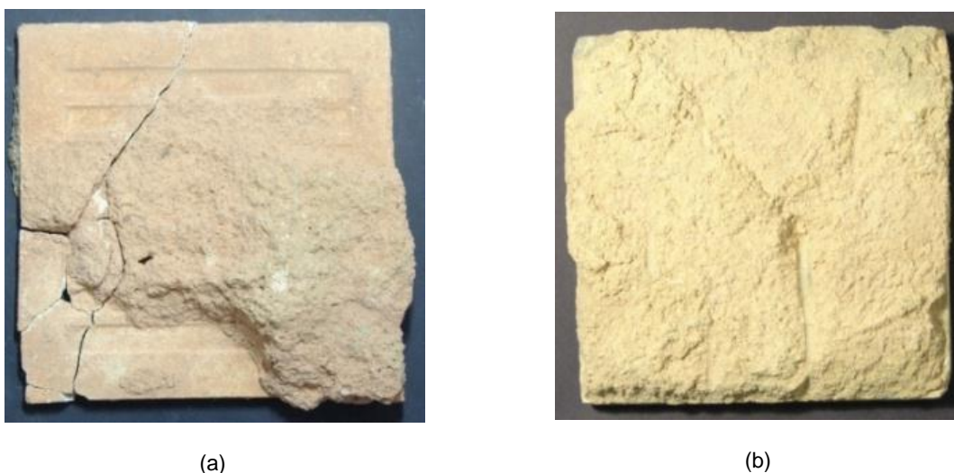
Figura 3. 28 – (a) Amostra PT-VO-A3 do Caso 1 e (b) amostra PT-SO-A3 do Caso 3 com, respectivamente, a menor e a maior percentual de área de argamassa aderida no tardo do azulejo.
