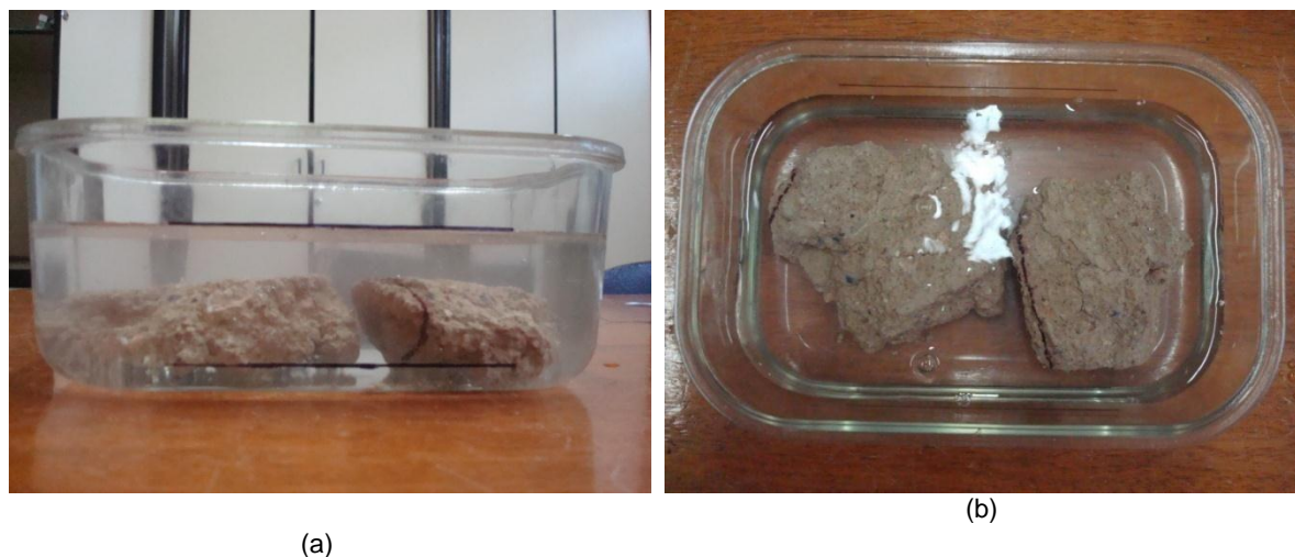
Figura 3. 10 – Ensaio de absorção total nas argamassas do Caso 1: (a) vista lateral e (b) vista superior do recipiente.
