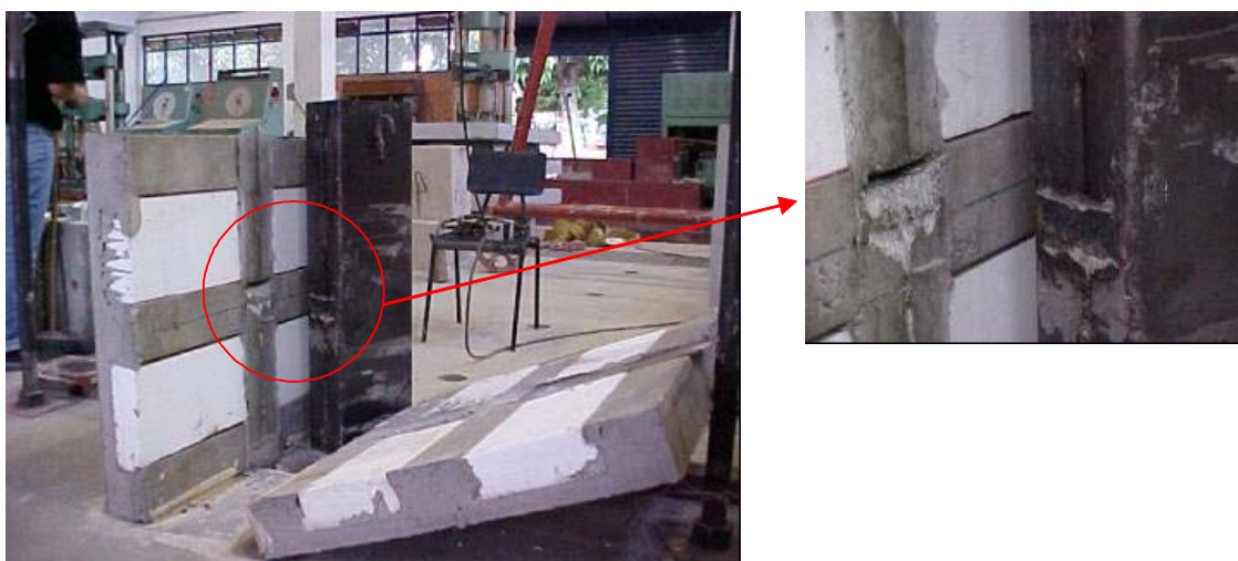
Figura 0.35 – Forma de ruptura dos modelos com conector de 100 mm de altura e espessura de 2,00 mm.
