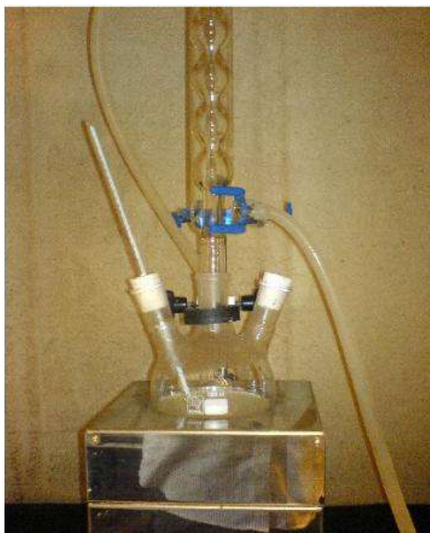
Figura 3.11: Arranjo experimental utilizado para a síntese de Hidrólise Forçada do CoO.
