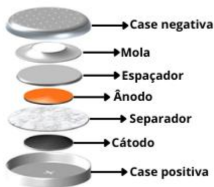
Figura 12: Esquema ilustrativo célula tipo moeda (Coincell). Adaptado Xue et al. 71
