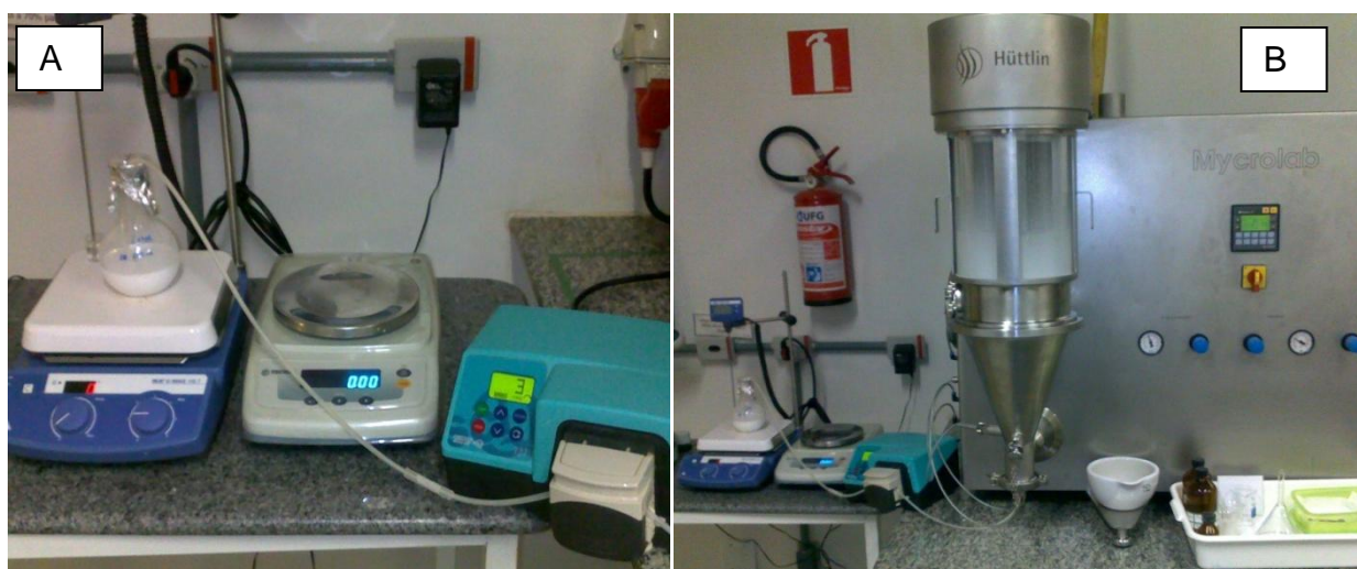
Figura 25: (A) Revestimento dos pellets: Bomba peristáltica (Watson Marlow®, 323); (B) Leito fluidizado (Mycrolab- H00264-Hüttlin®- FS).
