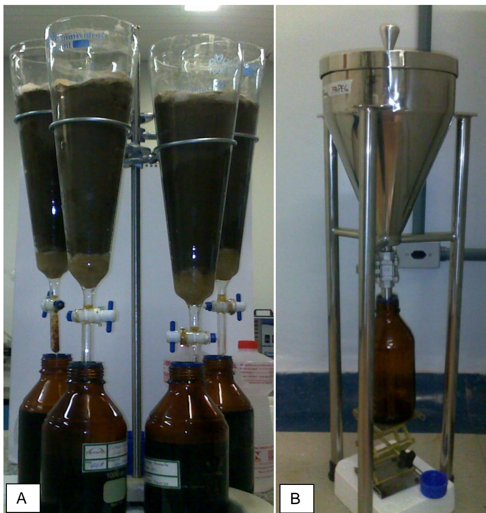
Figura 20: Percoladores utilizados: (A) Percoladores de vidro; (B) Percolador de metal.
