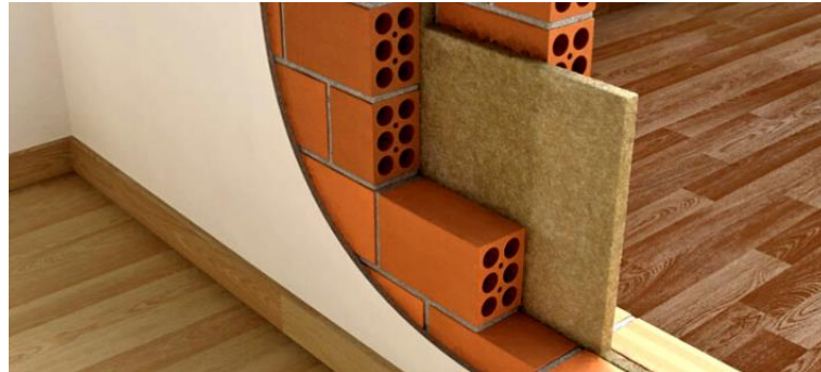
Figura 1.1 - Isolamento acústico interno em paredes.
