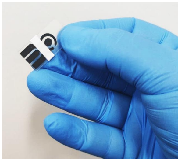
Figura 3.3. Imagem real de eletrodo de grafite-negro de fumo impresso em estêncil com 10% m/m de NF. Fonte: Autoria própria.
