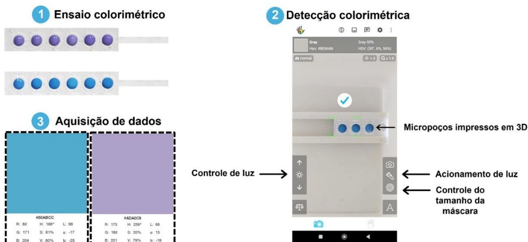
Figura 5.2. Representação esquemática do procedimento utilizado para aquisição de valores RGB utilizando o protótipo impresso em 3D e o aplicativo móvel Color Grab. Fonte: Autoria própria.
