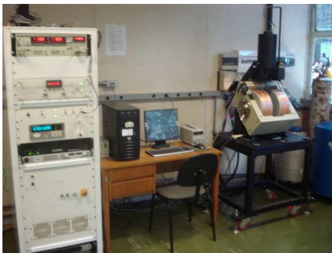
Figura 4.4 : Magnetômetro de amostra vibrante do laboratório de Magnetometria do Instituto de Física da UFG. Figura 2
