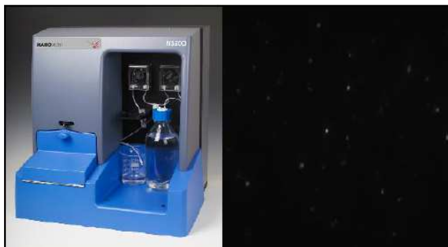
Figura 4.8 : Equipamento NanoSight NS500, à esquerda, e à direita uma imagem feita pelo software NTA Software Suite referente a visualização da população de uma amostra em análise
