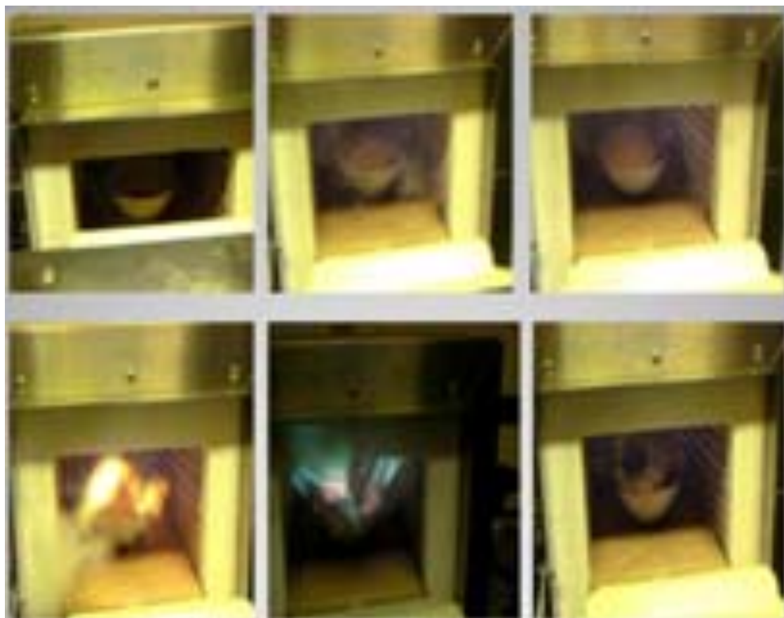
Figura 2.3. Etapas da combustão em forno mufla, onde temos em sentido horário, aquecimento da solução, início da formação da espuma, espuma polimérica pré-chama, instante da ignição, chama (duração ~ 10s) e pó formado.
