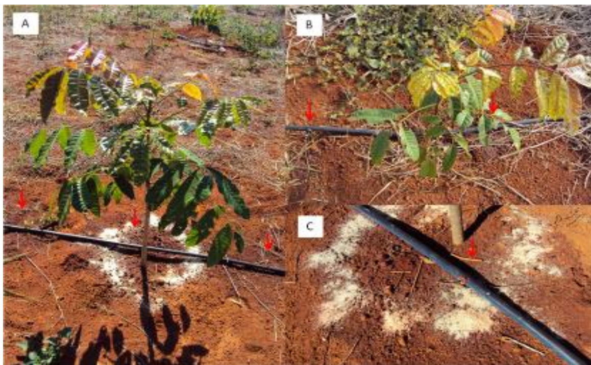
Figura 3.7. Detalhe da disposição dos gotejadores e bulbo molhado característico, em campo. Tratamento com 3 gotejadores (A), 2 (B) e com 1 gotejador por planta (C).
