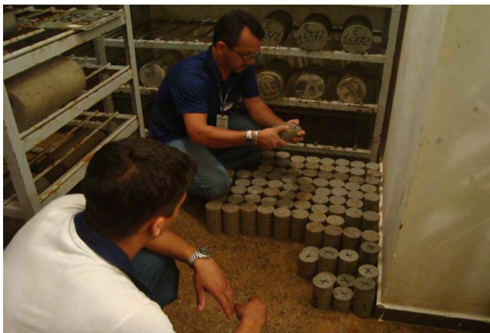
Figura 3.7 – Conjunto de corpos-de-prova retirados das placas e dos túneis em condições de armazenamento e cura em câmara úmida.
