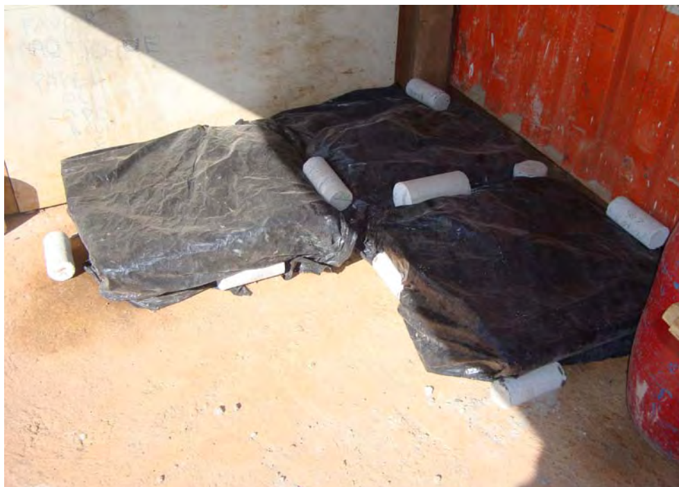
Figura 3.6 – Conjunto de placas produzidas numa sequência de moldagem com proteção de capa plástica.
