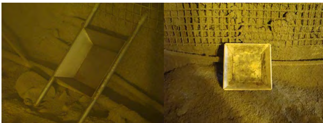
Figura 3.2 – Placa metálica (esquerda) e placa de madeira (direita) para moldagem de corpos-de-prova.
