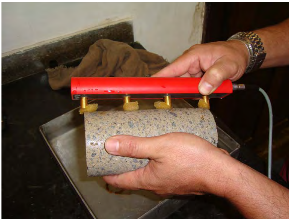
Figura 3.24 - Medição da resistividade elétrica superficial em corpo-de-prova de concreto projetado.
