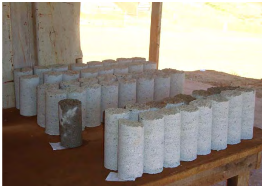
Figura B 5 – Corpos-de-prova retirados da placa – separados por sistema de projeção (via seca e via úmida).
