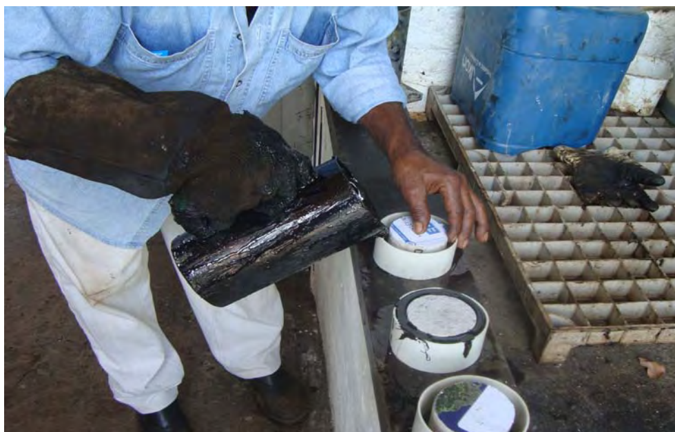
Figura 3.25 – Capeamento lateral dos corpos-de-prova de 75 mm com liga asfáltica, dentro do tubo de PVC de 100 mm.
