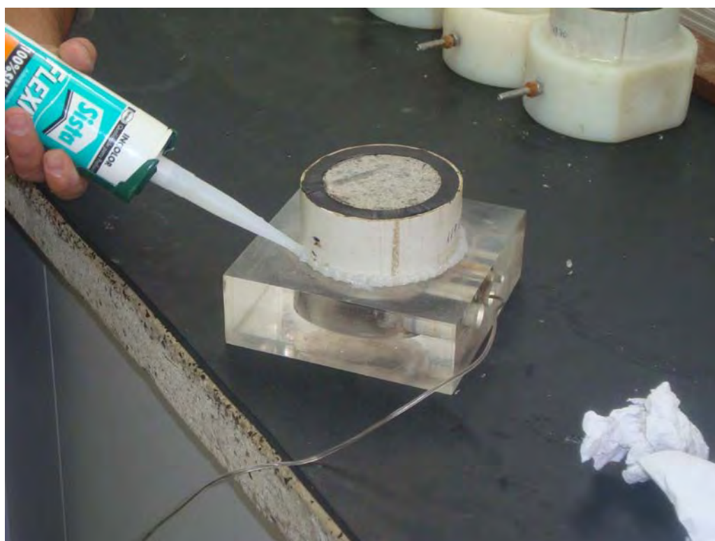
Figura 3.27 – Amostra colada e vedada com silicone transparente nas semi-células em acrílico.
