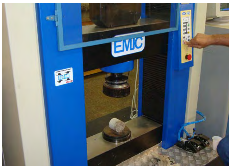
Figura 3.20 – Rompimento diametral dos corpos-de-prova do ensaio de penetrabilidade de água sob pressão - Furnas Centrais Elétricas S.A.
