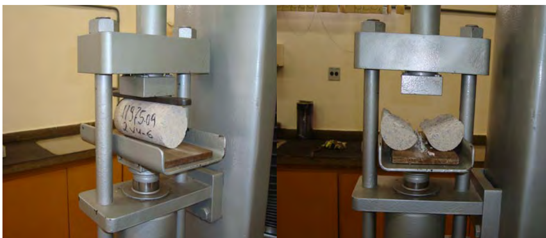
Figura 3.14 – Rompimento dos corpos-de-prova para medição do nível de penetração nos ensaios de absorção capilar
