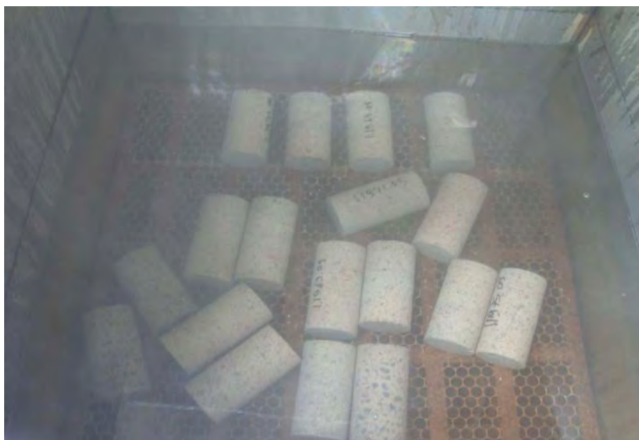
Figura 3.16 – Realização do ensaio de absorção por imersão – detalhe realização da fervura - Furnas Centrais Elétricas S.A.
