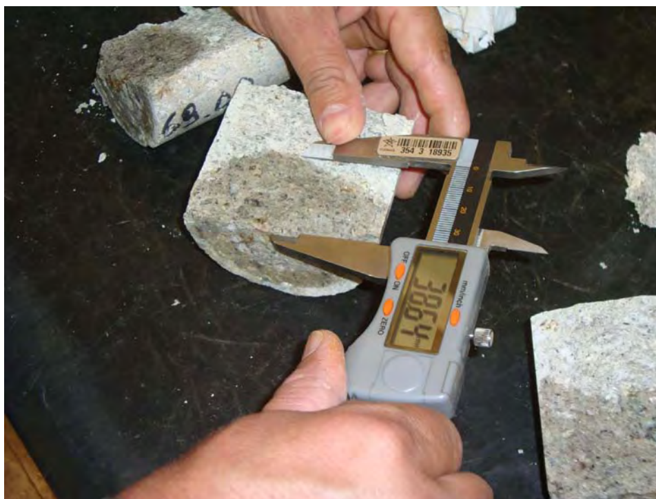
Figura 3.22 – Medição, no corpo-de-prova, da altura de penetração da frente de umidade com paquímetro digital.
