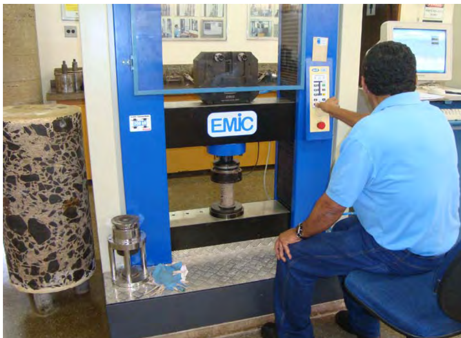
Figura 3.30 – Realização de ensaio de compressão axial aos 28 dias dos corpos-de-prova das placas e extraídos dos túneis.
