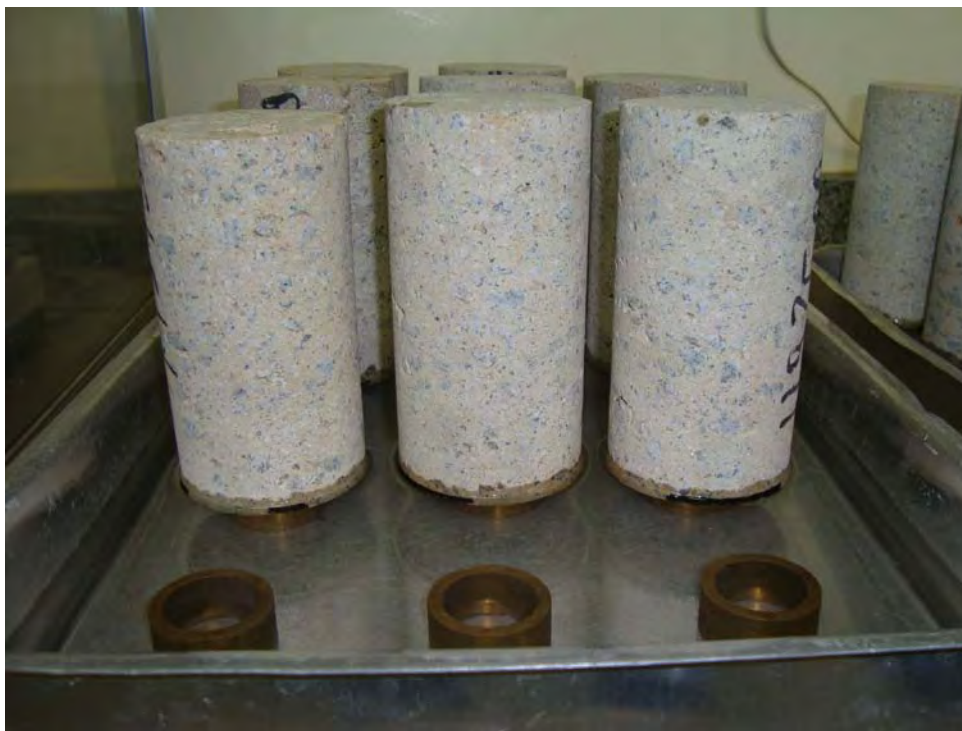
Figura 3.13 – Realização do ensaio de absorção por capilaridade – detalhe do anel metálico como regulador da altura do nível da água nos corpos-de-prova - Furnas Centrais Elétricas S.A.
