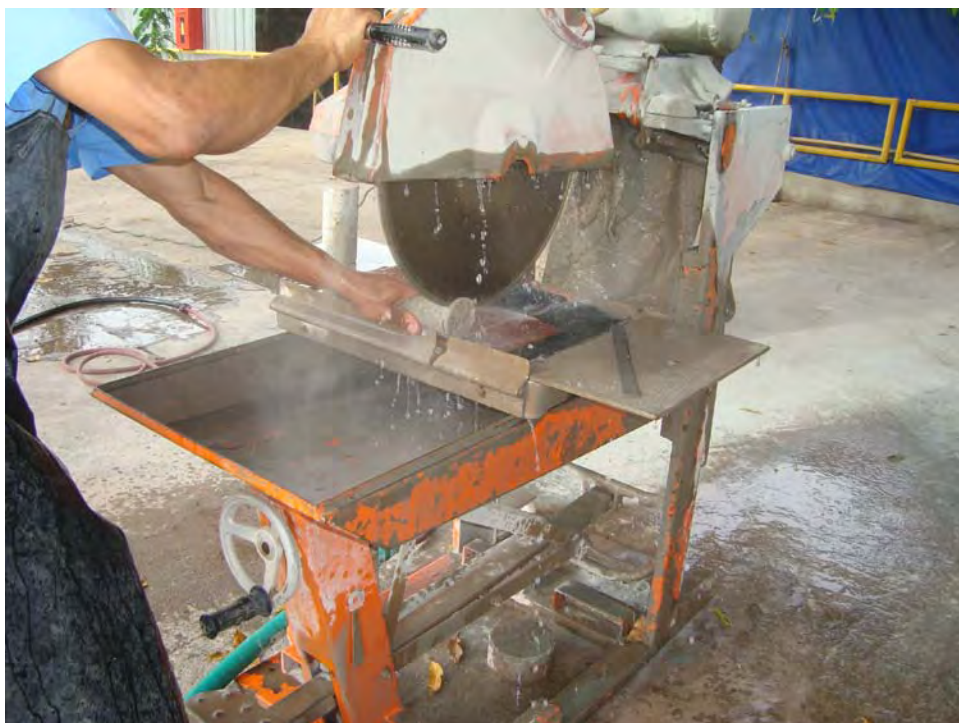
Figura C 1 – Máquina de corte de concreto para corpos de prova para o tamanho de realização dos ensaios - Centro Tecnológico de Engenharia Civil de Furnas Centrais Elétricas
