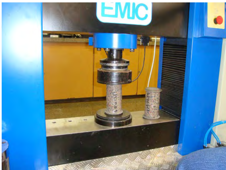
Figura 3.31 - Realização de ensaio de compressão axial aos 28 dias dos corpos-de-prova das placas e extraídos dos túneis.
