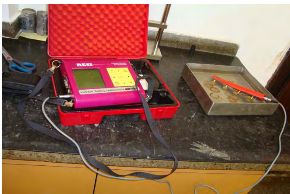
Figura 3.23 – Aparelho de medição da resistividade elétrica – modelo RESI, marca Proceq – detalhe da saturação em água das esponjas posicionadas nas extremidades dos eletrodos, previamente ao início das medições.
