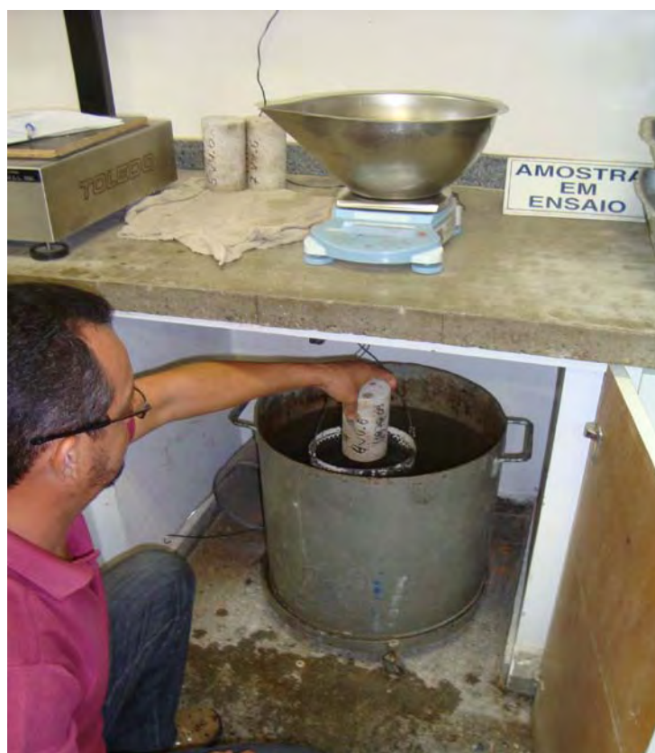
Figura 3.17 – Determinação da massa imersa em água no ensaio de absorção por imersão, utilizando-se balança hidrostática.
