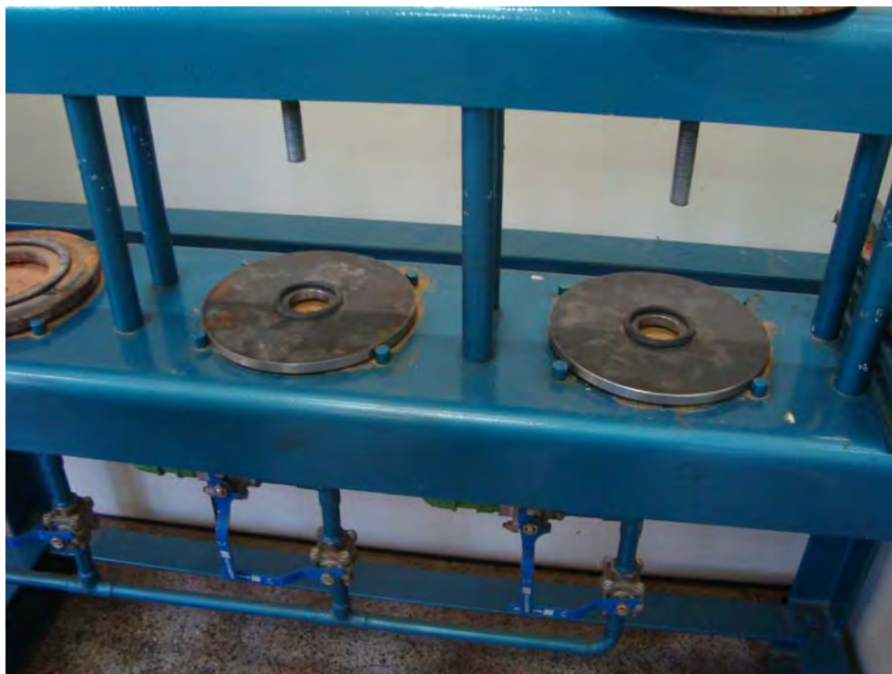
Figura 3.18 – Detalhe do disco de liga de aço, confeccionado para este programa experimental visando a adaptação às dimensões dos corpos-de-prova – ensaio de penetrabilidade de água sob pressão.
