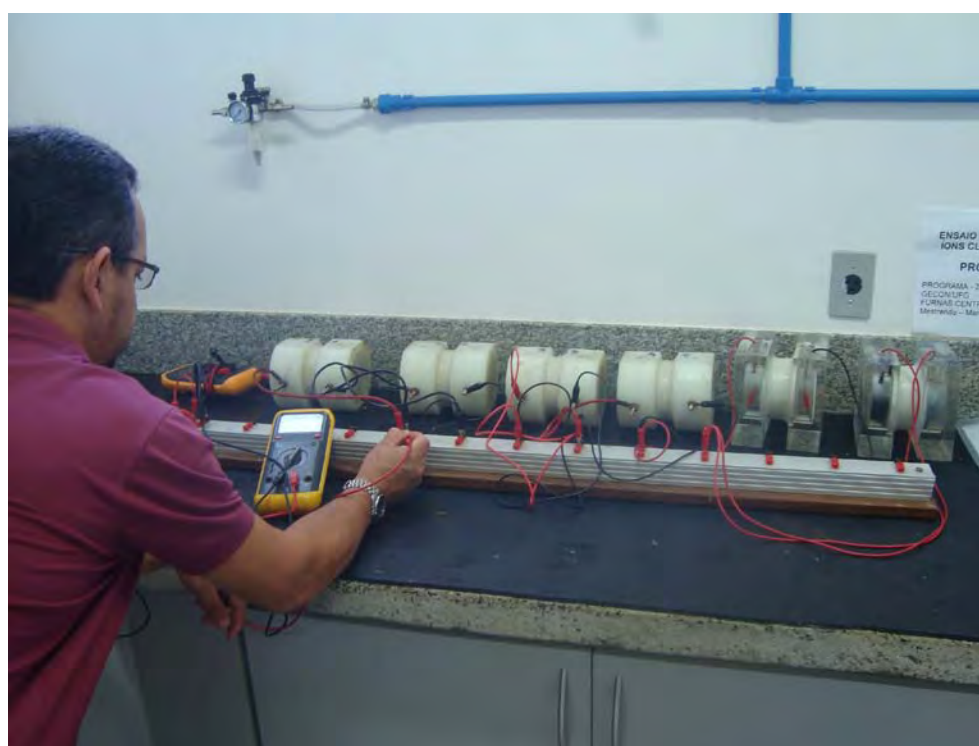
Figura 3.29 – Leitura das medições das correntes no ensaio de penetrabilidade de íons cloreto.
