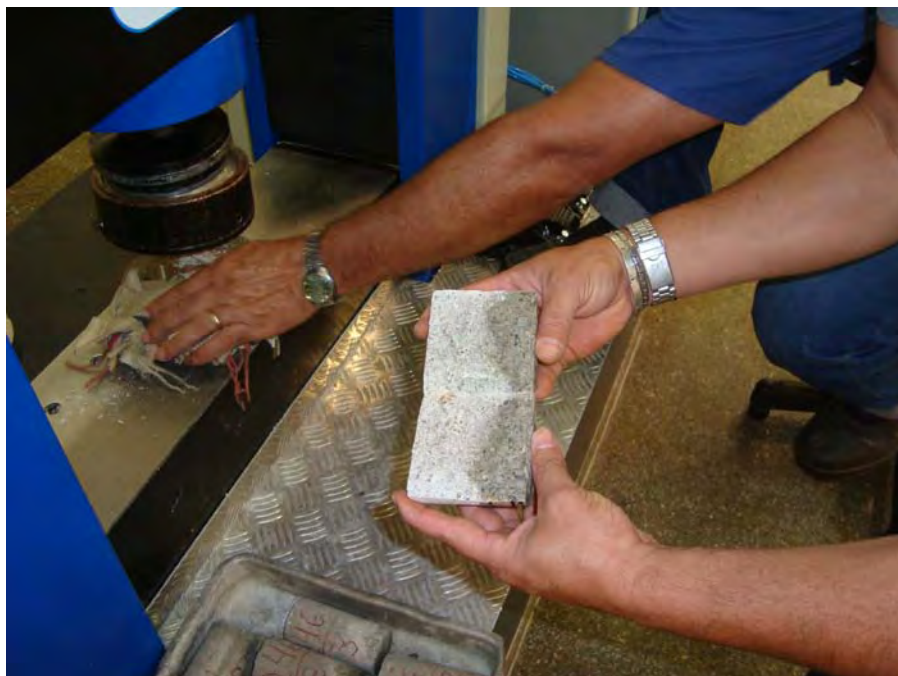
Figura 3.21 – Detalhe do nível de penetração da água nos corpos-de-prova após rompimento no ensaio de penetrabilidade de água sob pressão.
