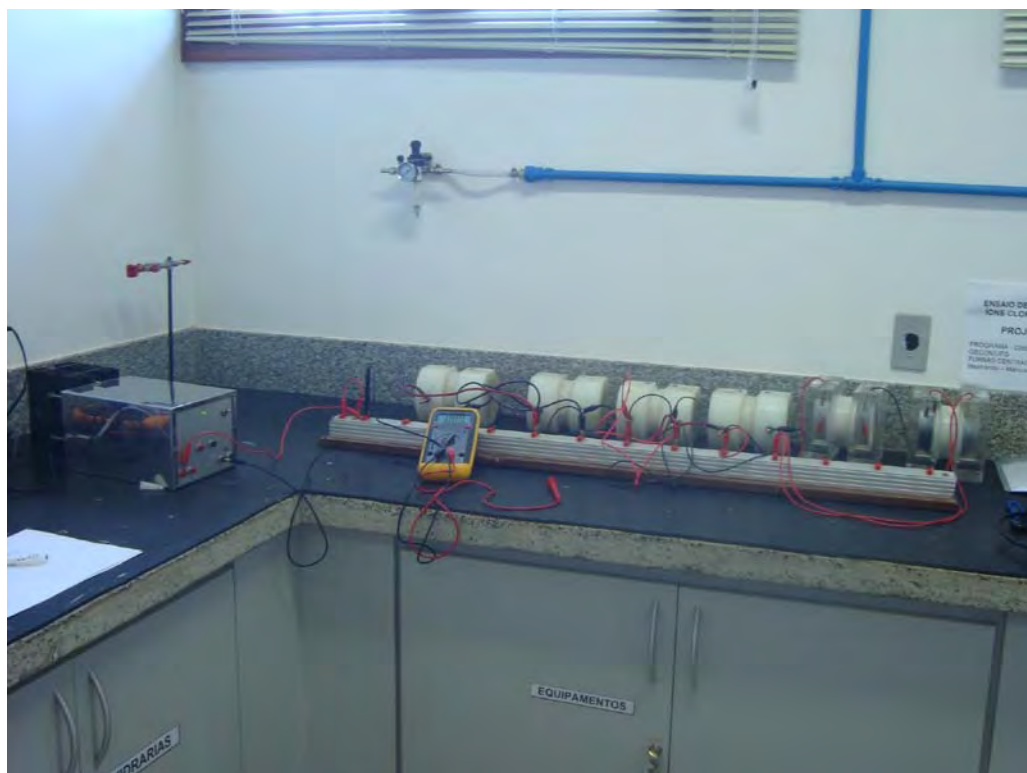
Figura 3.28 – Disposição esquemática do ensaio de penetrabilidade de íons cloreto.
