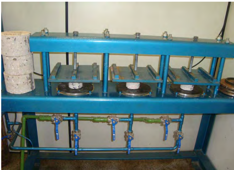
Figura 3.19 – Realização de ensaio de penetrabilidade de água sob pressão – detalhe do aparelho com pressão de 0,7 MPa – NBR 10787:1994 (ABNT, 1994).
