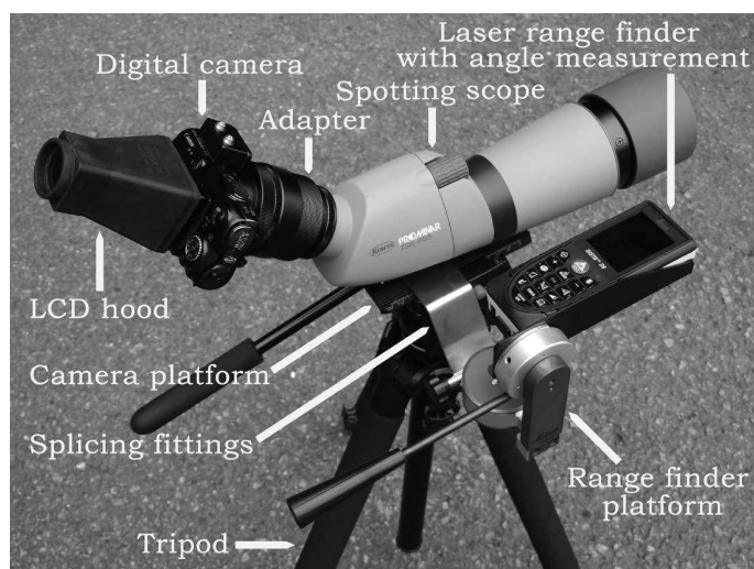
Figura 2.5: Sistema desenvolvido usando a câmera digital e lente teleobjetiva (SHIMIZU et al., 2014).
