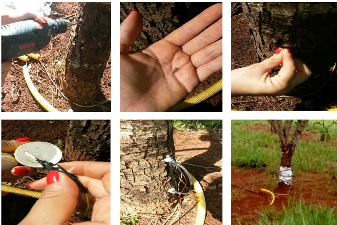
Figura 6. Instalação das sondas de dissipação térmica em pomar de pequi, cultivado em Goiânia-GO, 2016. Perfuração do caule a 0,15 m do solo (a), cápsula de alumínio (b), inserção da cápsula no tronco (c), revestimento da sonda em pasta térmica (d), detalhe da sonda instalada (e) e revestimento do caule com papel laminado (f)
