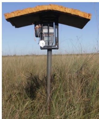
Figura 2- Estrutura instalada, no Parque Nacional da Emas, no ponto 7 (lat: -18,169181; long: -53,010745; alt: 807,12), com gravador (dentro da estrutura) e datalogger (fora da estrutura).
