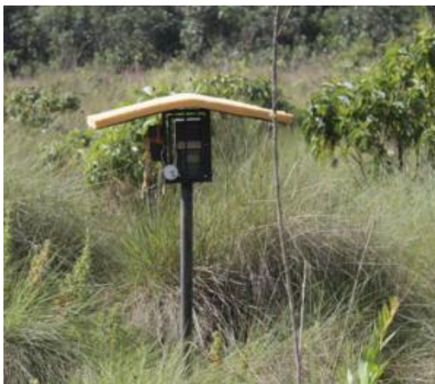
Figura 1- Equipamentos (gravador e datalogger) instalados no ponto 2.
