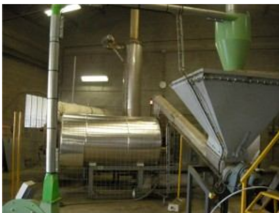
Figura 29: Unidade de produção de biochar: Pyro-6F. Fonte: Pro-Natura (2015).
