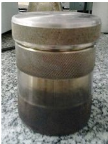
Figura 34: Reator de Carbonização Hidrotermal.
