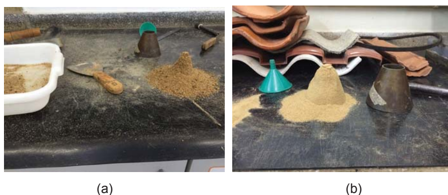
Figura A.6 – Areia grossa (a) e fina (b) em condição de saturado com superfície seca.
