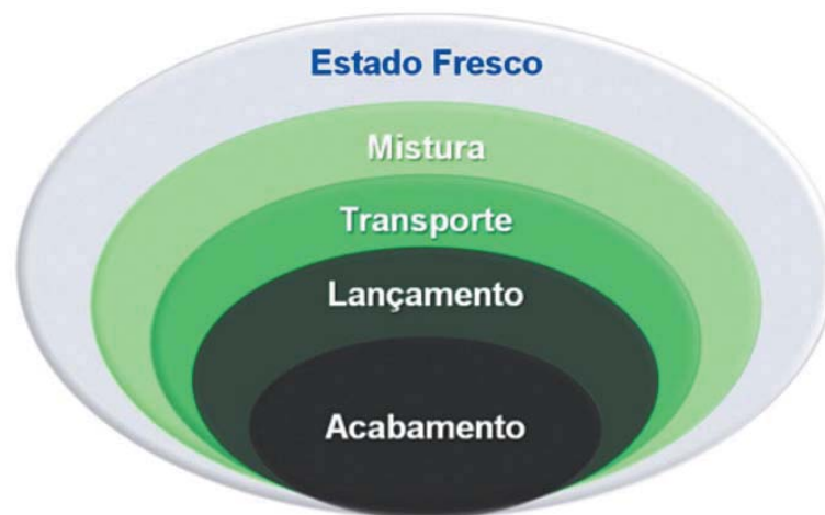
Figura 2.28 – Ilustração esquemática do conceito abrangente de trabalhabilidade, envolvendo as etapas de mistura, transporte, lançamento e acabamento (ROMANO; CARDOSO; PILEGGI, 2011).
