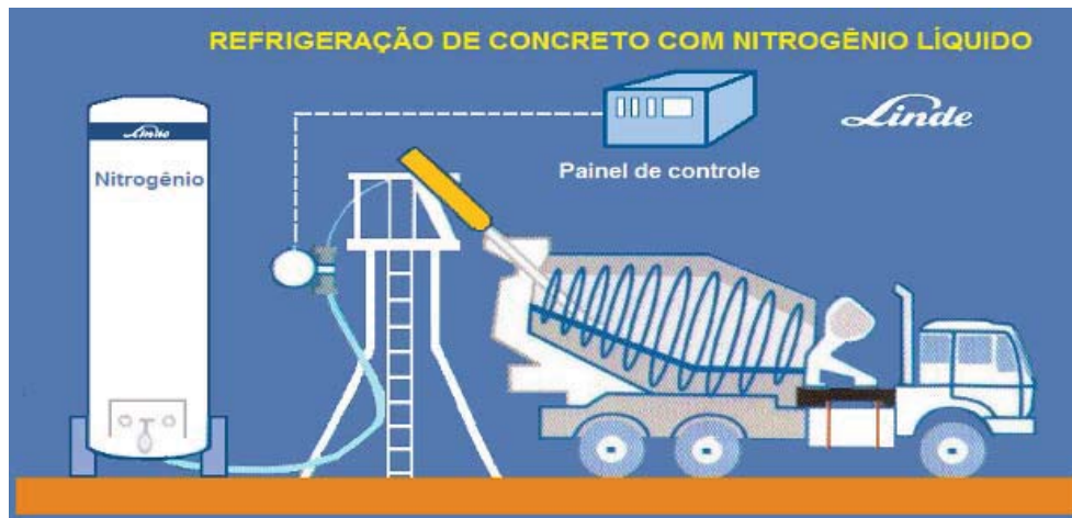
Figura 2.18 – Esquema de injeção de nitrogênio líquido (FREITAS JUNIOR, 2013).
