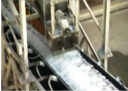
Figura 2.16 – Gelo raspado utilizado na fundação do edifício Villa Serena Residence (FREITAS JUNIOR, 2013).
