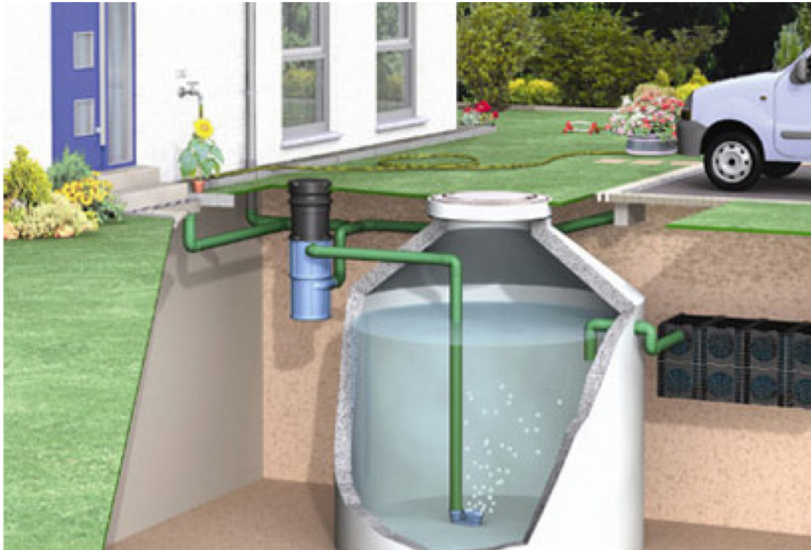
Figura 26. Reservatório individual enterrado.
