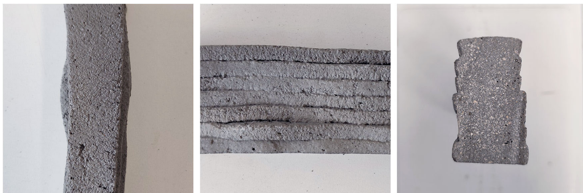
Figura 119 - Caracterização visual do corpo de prova da mistura M0,6-REF-SA: (a) superfície superior; (b) vista lateral das camadas extrudadas; (c) seção transversal após corte
