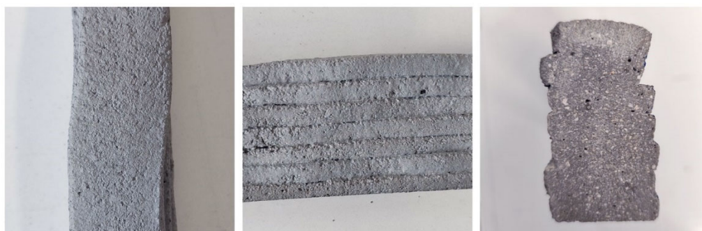
Figura 116 - Caracterização visual do corpo de prova da mistura M0,6-REF: (a) superfície superior; (b) vista lateral das camadas extrudadas; (c) seção transversal após corte
