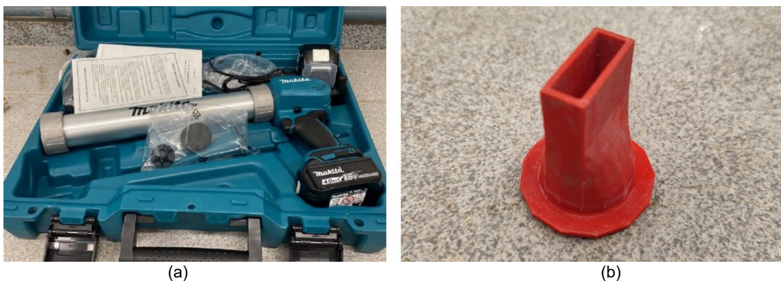
Figura 33 - Equipamento utilizado nos testes de extrusão: (a) pistola aplicadora Makita DCG180RMEB; (b) bico adaptado com seção retangular (10 × 30 mm)
