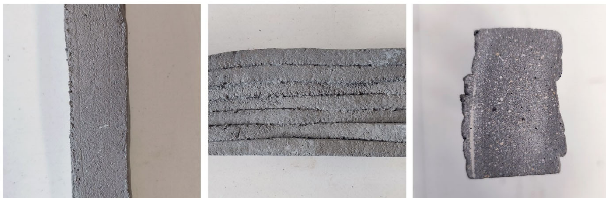
Figura 123 - Caracterização visual do corpo de prova da mistura M0,55-SP3,75: (a) superfície superior; (b) vista lateral das camadas extrudadas; (c) seção transversal após corte
