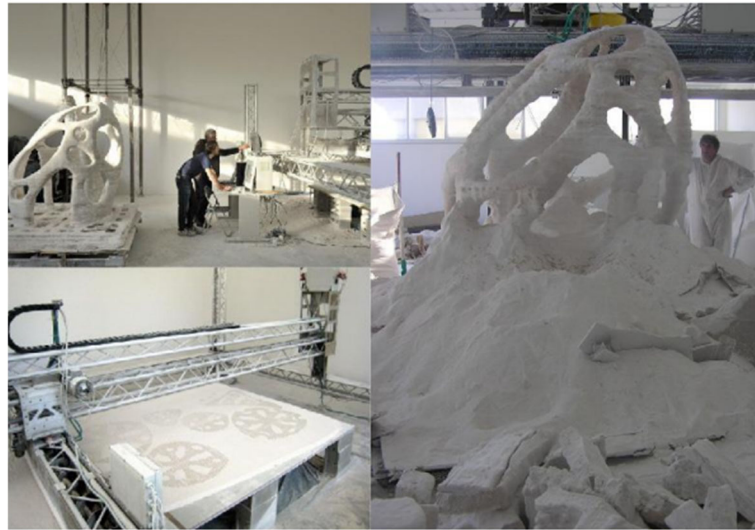
Figura 3 - Tecnologia de Impressão 3D D-Shape
