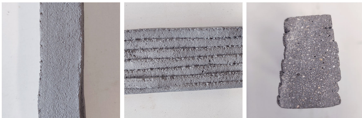
Figura 121 - Caracterização visual do corpo de prova da mistura M0,6-SP2,75-SA: (a) superfície superior; (b) vista lateral das camadas extrudadas; (c) seção transversal após corte
