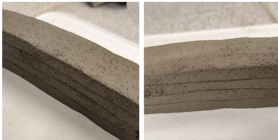
Figura 35 - Empilhamento de camadas de argamassa para verificação de estabilidade.
