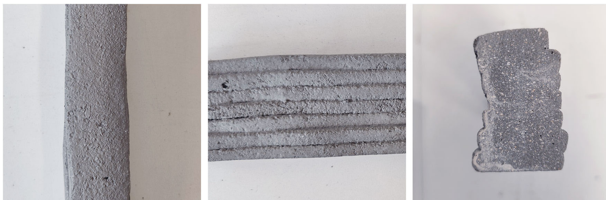
Figura 125 - Caracterização visual do corpo de prova da mistura M0,55-SP3,5-SA: (a) superfície superior; (b) vista lateral das camadas extrudadas; (c) seção transversal após corte
