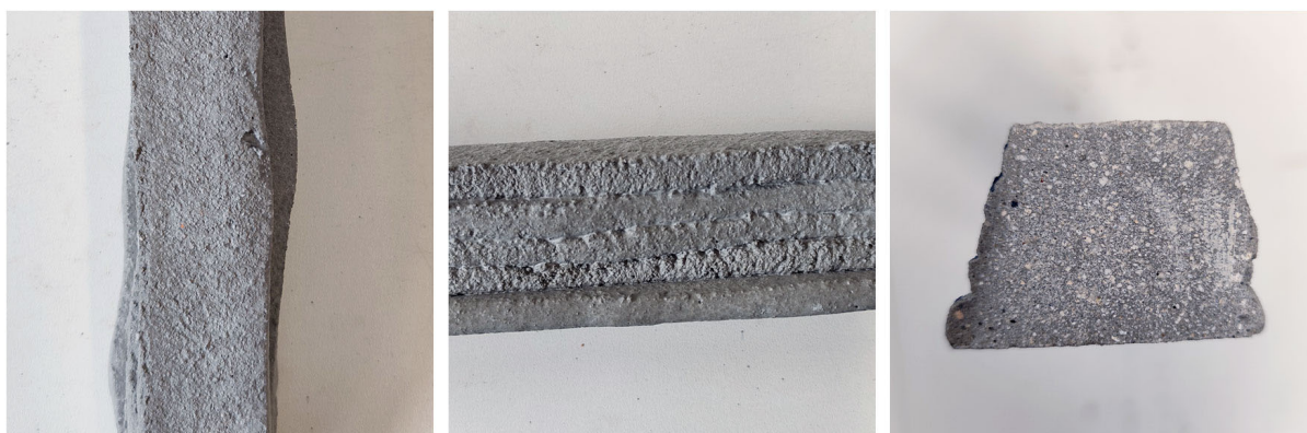
Figura 126 - Caracterização visual do corpo de prova da mistura M0,55-SP3,75-SA: (a) superfície superior; (b) vista lateral das camadas extrudadas; (c) seção transversal após corte
