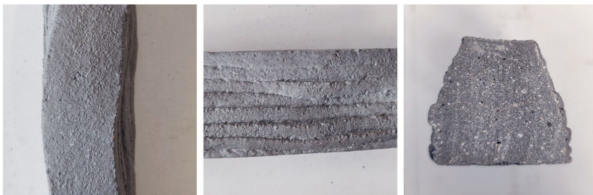
Figura 118 - Caracterização visual do corpo de prova da mistura M0,6-SP3: (a) superfície superior; (b) vista lateral das camadas extrudadas; (c) seção transversal após corte
