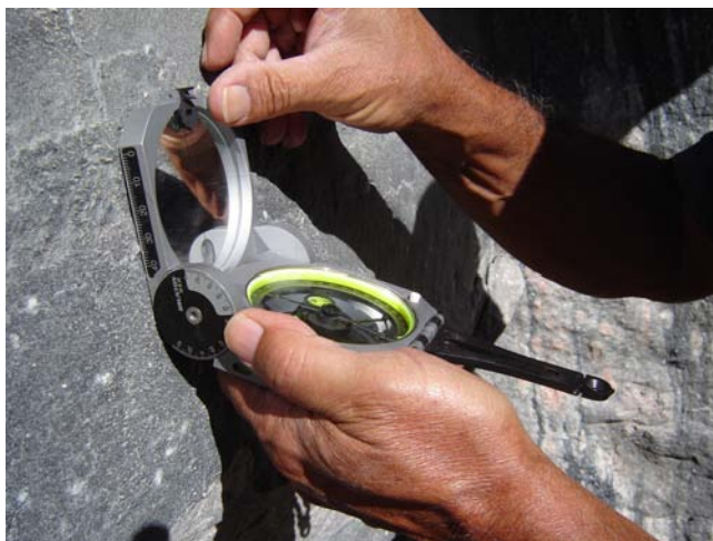
Figura 5.3. – Levantamento estrutural do maciço em campo.
