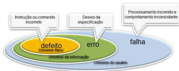
Figura 2.1: Defeitos X Erros X Falha (extraída de Delamaro, Maldonado e Jino (2007) ).
