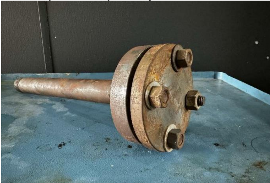
Figura 3.15 – Montagem do tubo para o ensaio hidrostático.
