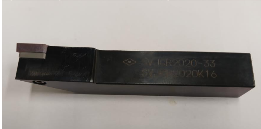
Figura 3.10 – Conjunto ferramenta utilizado na usinagem de acabamento dos tubos.
