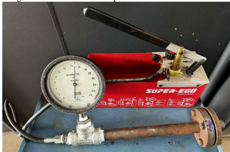
Figura 4.13 - Sistema montado e pressurizado no ensaio hidrostático.
