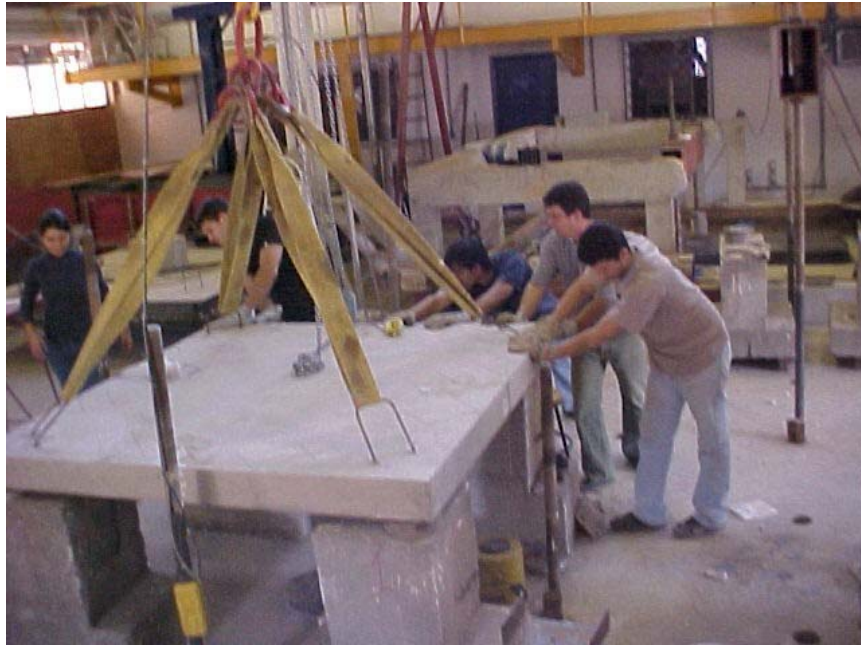
Figura G.7 – Fixação da laje orientando-se pelos prumos – força manual
