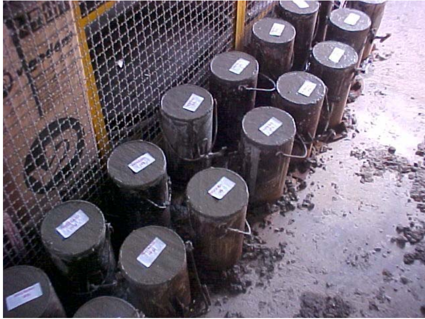
Figura G.5 – Corpos-de-prova moldados
