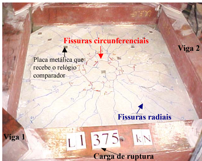
Figura 4.27 – Fissuração da laje L1
