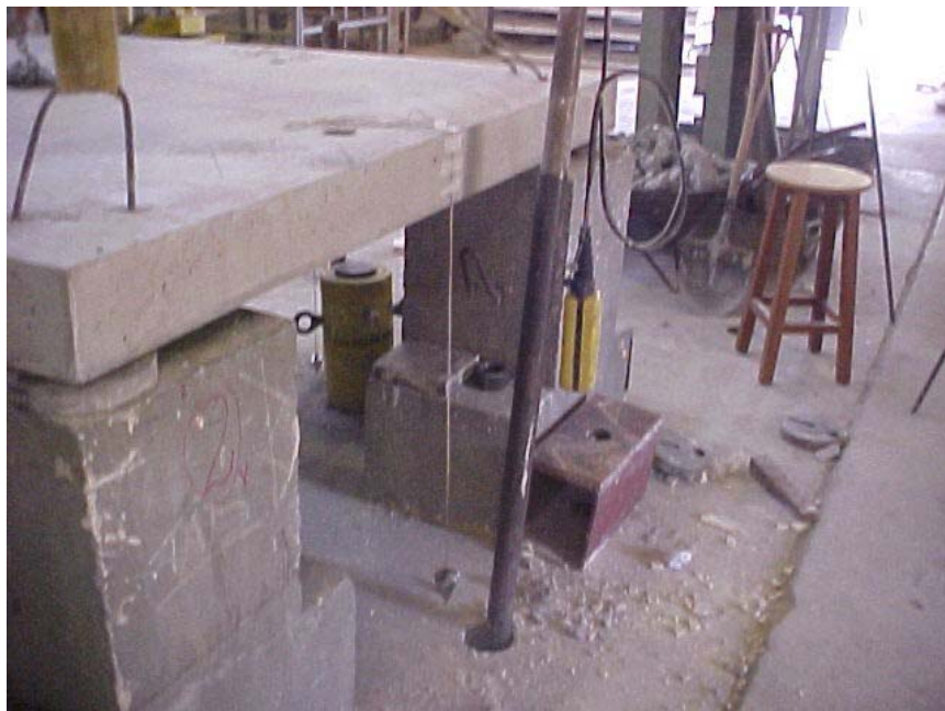
Figura G.8 – Laje posicionada para ser ensaiada
