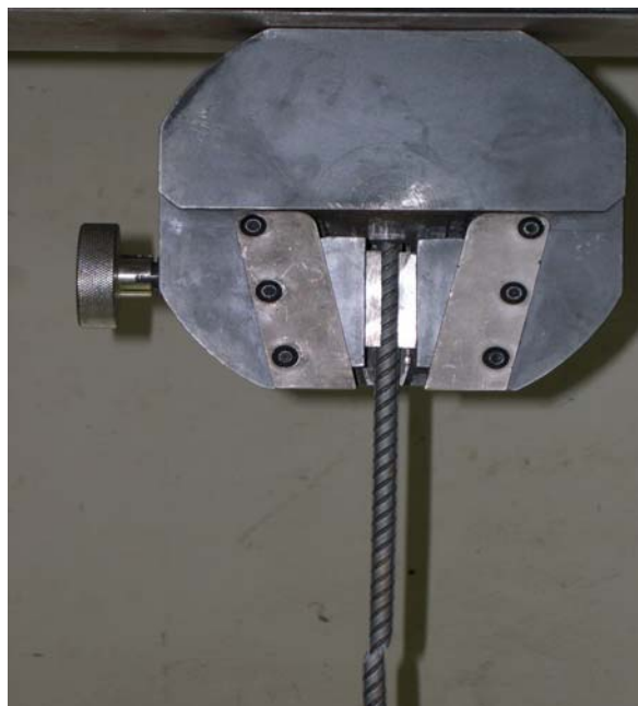
Figura G.12 – Aço rompido na prensa
