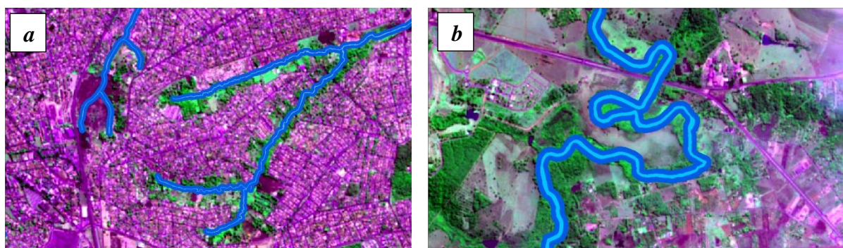
Figura 36 – Aplicação da ferramenta buffer e definição de faixas de 30m em canais com até 10m de largura (parte a ); e faixas de 50m em canais com largura variando de 10 a 50m (parte b ).
