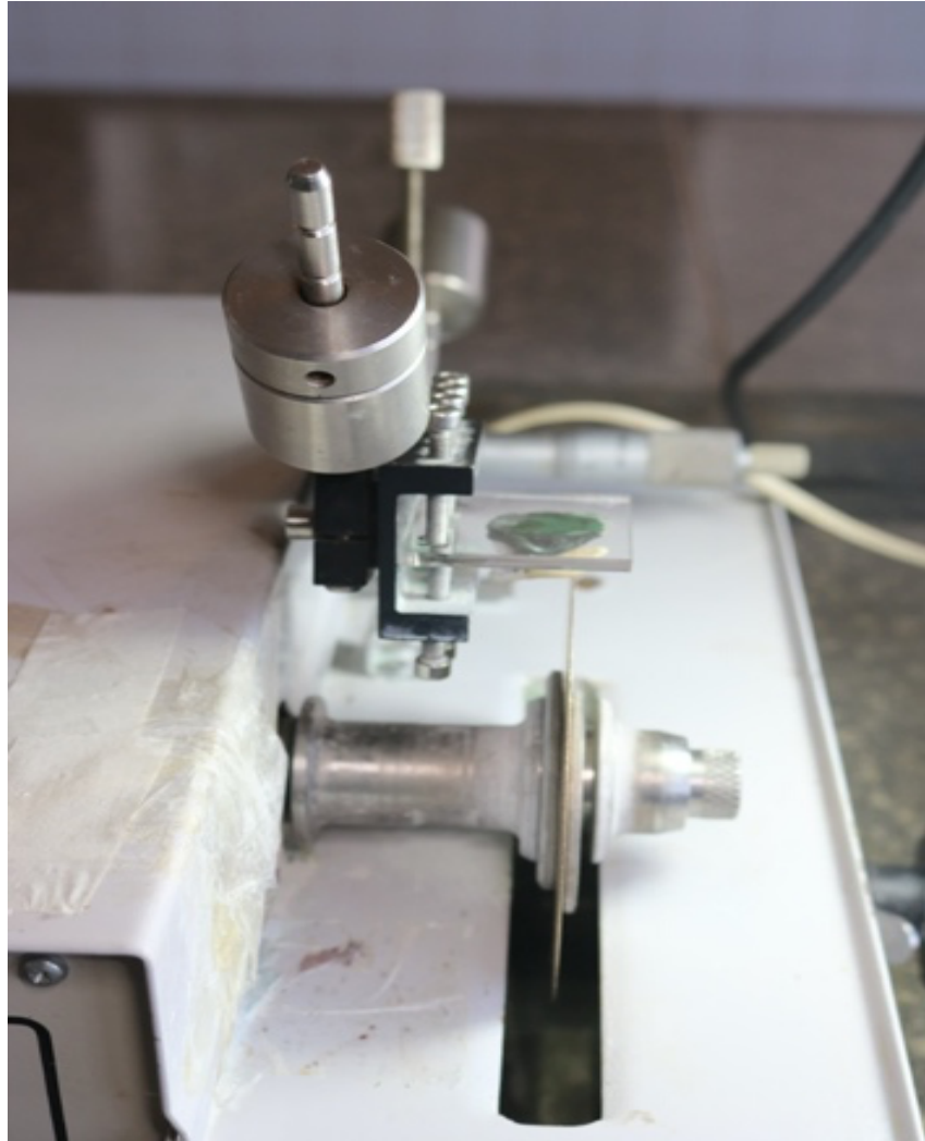
Figura 5. Disco diamantado inserido no micrótomo Isomet para realizar o corte das raízes no sentido mesiodistal a 6 mm do ápice radicular.
