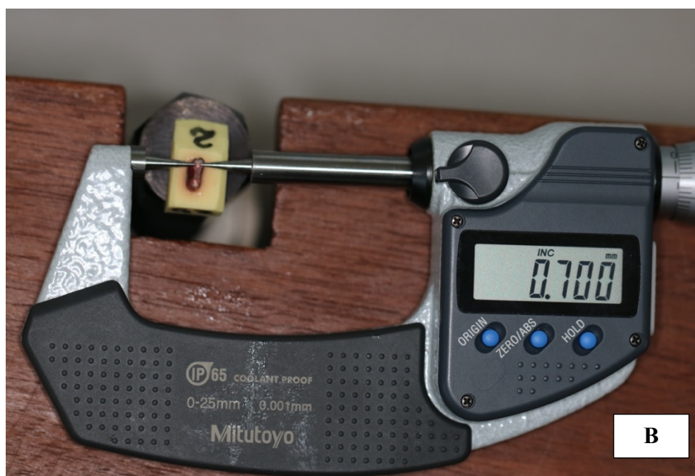
Figuras 13 (A) Imagem do micrômetro digital na plataforma nivelada; (B) Imagem do micrômetro digital na plataforma nivelada e elevador metálico.
