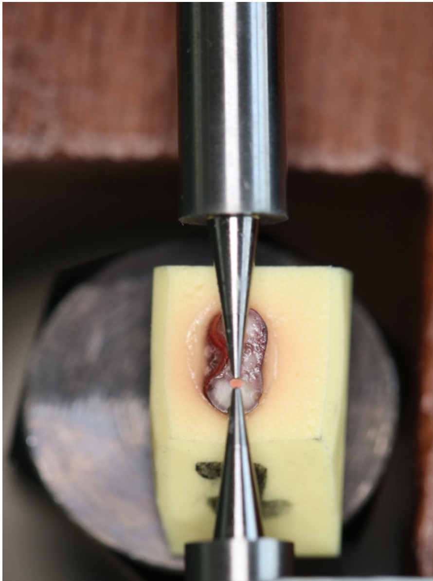
Figura 15. Imagem da superfície da amostra com ponta ativa do micrômetro digital posicionado no eixo Y, em aumento de 25x.
