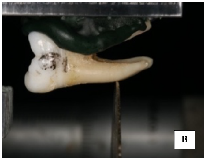
Figura 4. (A) Imagem do micrótomo Isomet e disco diamantado de dupla face; (B) Micrótomo Isomet com disco dupla face posicionado em 6 mm do ápice radicular.
