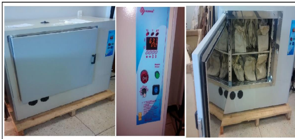
Figura 15. Estufa de circulação e renovação de ar com as amostras dos componentes do estrato herbáceo-arbustivo e necromassa coletados para avaliação de biomassa seca.
