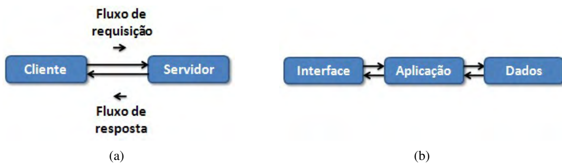
Figura 2.14: (a) Arquitetura Cliente-Servidor ; (b) Arquitetura MVC (Modelo, Visão e Controle) .
