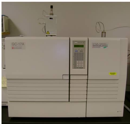
Figura 14- Cromatógrafo gasoso acoplado ao espectrômetro de massas, Shimadzu QP5050A (Kyoto, Japão).
