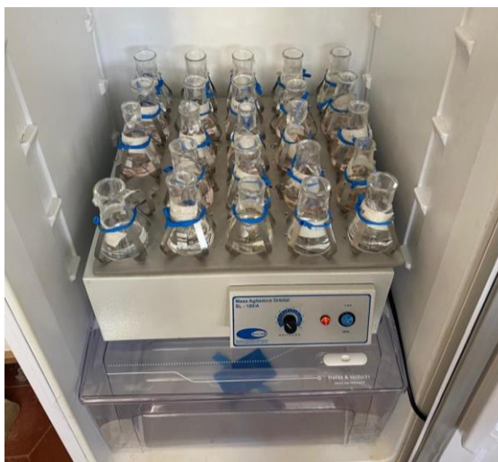
Figura 6 - Ensaios de adsorção realizados em mesa agitadora, em câmara climática controlada.
